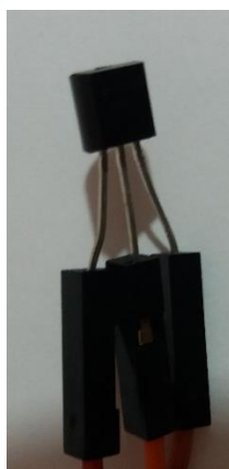
Figura 3.6. Sensor de temperatura LM35- utilizado como forma de avaliar indiretamente a atividade do ramo Simpático do Sistema Nervoso Autônomo. Esta primeira tentativa não foi bem-sucedida, e o sistema para essa medida foi substituída por outra alternativa.
