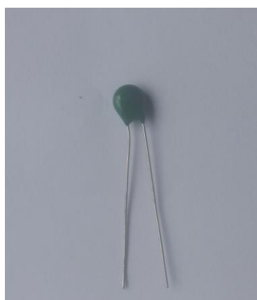
Figura 3.7 Sensor de temperatura Termistor NTC de 10K\Omega - utilizado como forma de avaliar indiretamente a atividade do ramo Simpático do Sistema Nervoso Autônomo. Esta segunda tentativa foi bem-sucedida.
