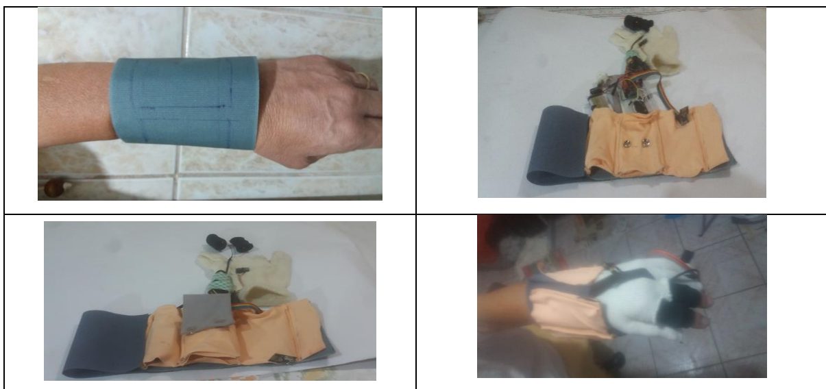
Figura 3.12: Luva-Pulseira englobando sensores, microcontrolador Arduino, bateria e módulo de transmissão. Abaixo à esquerda e acima à direita: vista explodida.
