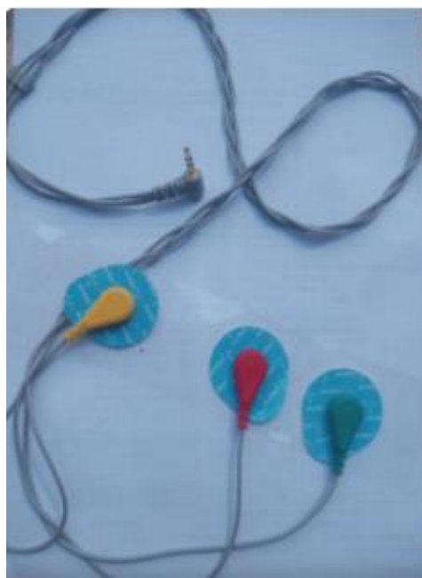
Figura 3.5.2 Eletrodos de Ag/AgCl utilizados juntamente com o módulo de ECG. Os condutores foram trançados, a fim de se reduzir a interferência eletromagnética dos 60Hz da rede.
