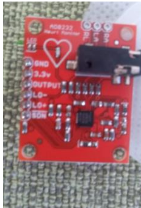
Figura 3.5.1 Módulo de ECG AD8232 - terceira tentativa (e bem-sucedida) para se detectar e mensurar a atividade cardíaca como forma de avaliar indiretamente a atividade do ramo Simpático do Sistema Nervoso Autônomo.
