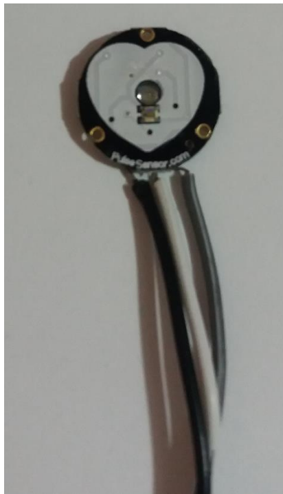
Figura 3.4.1: Módulo pulse sensor – primeira tentativa para mensurar a atividade cardíaca como forma de avaliar indiretamente a atividade do ramo Simpático do Sistema Nervoso Autônomo. Esse sistema não apresentou estabilidade e repetibilidade, e for substituído por outro.
