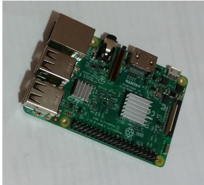
Figura 3.11: Mini PC Raspberry Pi 3 , utilizado na unidade de processamento dos sinais a serem enviados via Wi-Fi
