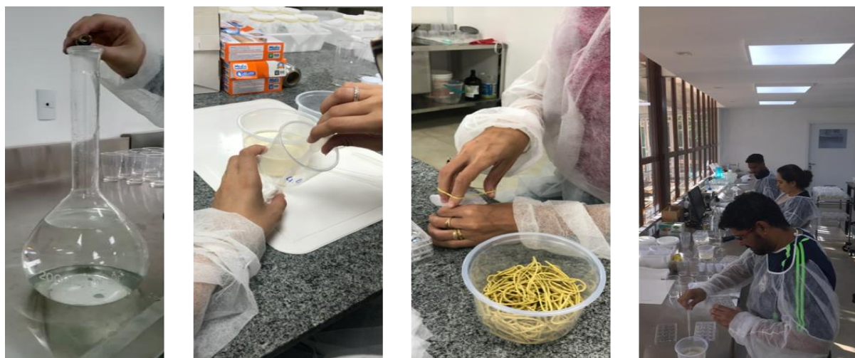
Figura 3. Montagem dos recipientes de teste. Diluição da amostra em balão volumétrico, separação e contagem de larvas e pupas e fechamento dos recipientes com tecido.
