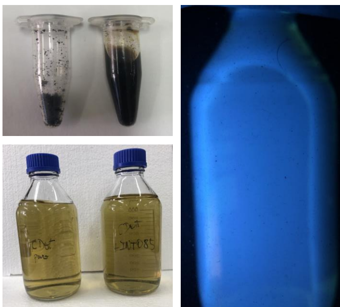
Figura 37. Carbon dot (CDot) em pó, em solução aquosa e em solução aquosa sob luz UV.
