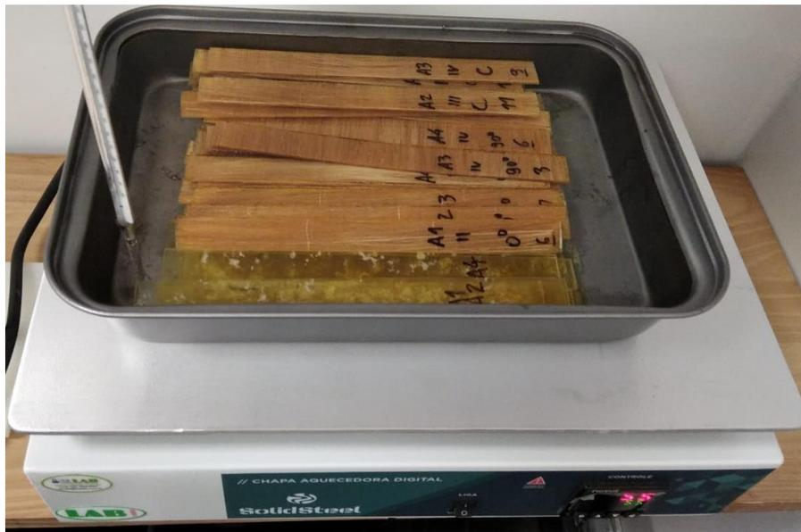
Figura 10 – Imersão dos corpos de prova de compósitos e resina epóxi pura.
