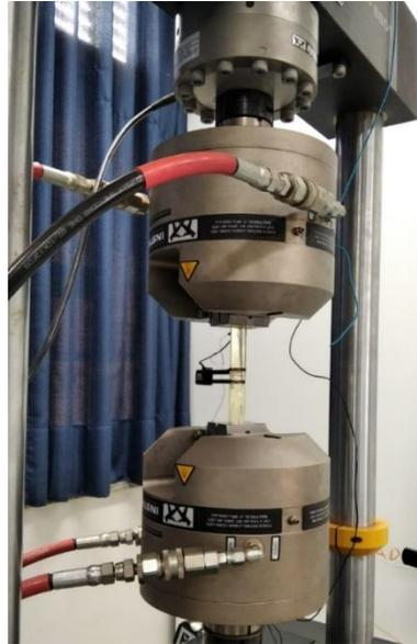
Figura 13 – Corpo de prova de epóxi puro com extensômetro durante teste na Instron 8801.
