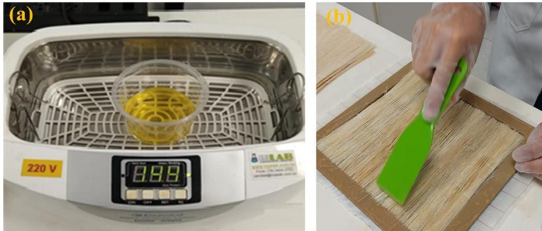
Figura 8 – Degasagem do sistema de resina epóxi e endurecedor (a) aplicação de resina epóxi sobre manta de sisal (b).
