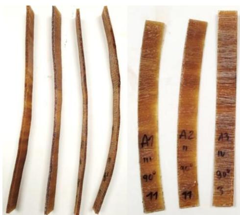
Figura 18 – Compósitos reforçados com fibras orientadas a 90° após a exposição higrotérmica.
