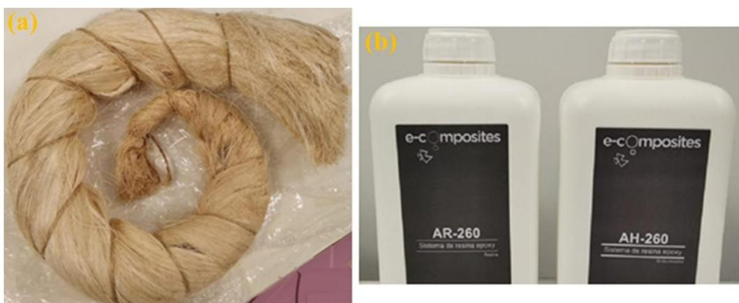
Figura 6 – Longos fios de fibras de sisal como fornecidos, sem tratamentos ou escovação (a) e sistema de resina epóxi AR-260 e endurecedor AH-260 (b).
