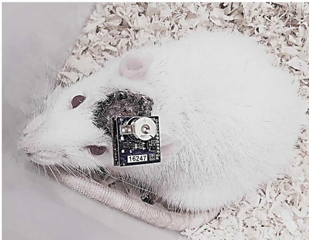
Figura 5. Animal conectado ao headstage do sistema wireless 8200-K9-SE3 da Pinnacle Technologies para captação de EEG.
