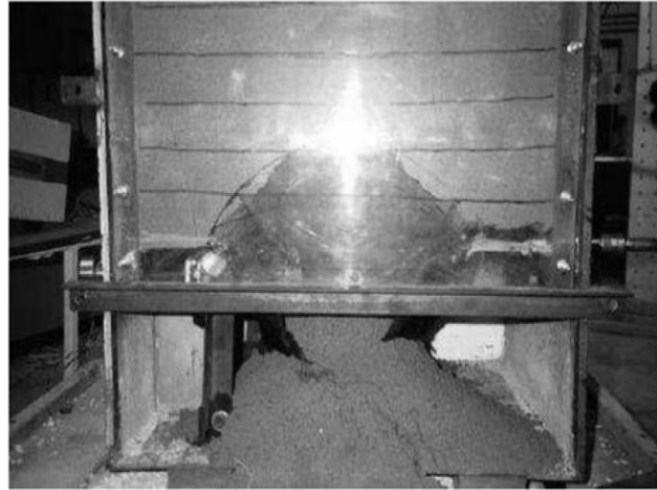
Figura 2.3 – Fenômeno de arqueamento do solo. (Horgan & Sarsby, 2002)
