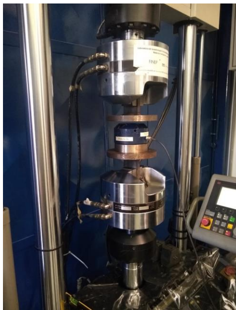
Figura 3.14 – Calibração da célula de carga.
