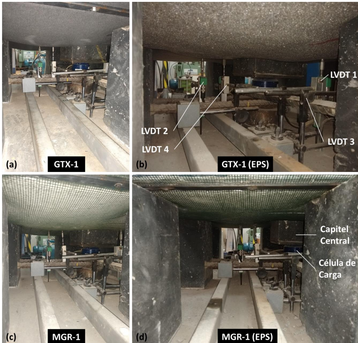
Figura 4.62 – Diferença visual dos recalques na base do aterro em ensaios com e sem o EPS.
