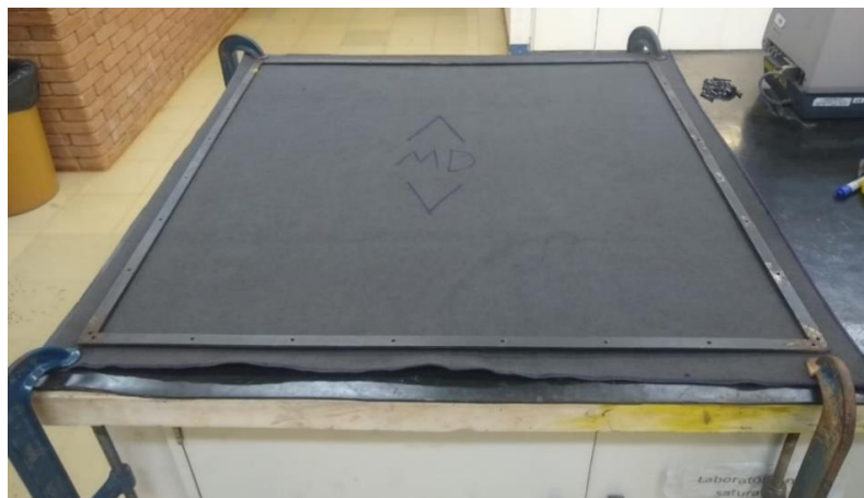
Figura 3.17 – Fixação do Geotêxtil Não-Tecido na moldura metálica.
