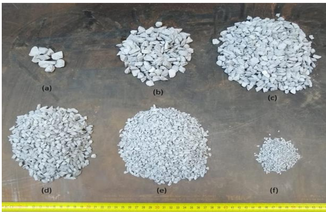
Figura 3.5 – Material de aterro retido nas peneiras: (a) 12,5 mm; (b) 9,5 mm; (c) 6,2 mm; (d) 4,8 mm; (e) 2,4 mm; (f) 2 mm.
