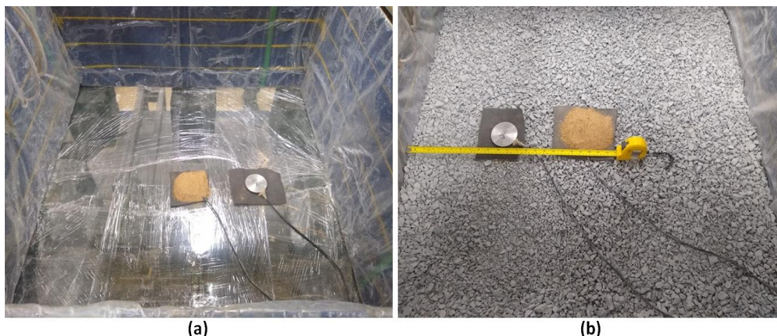
Figura 3.20 – Posicionamento das células de tensão total: (a) CTT 01 e CTT 02; (b) CTT 03 e CTT 04.
