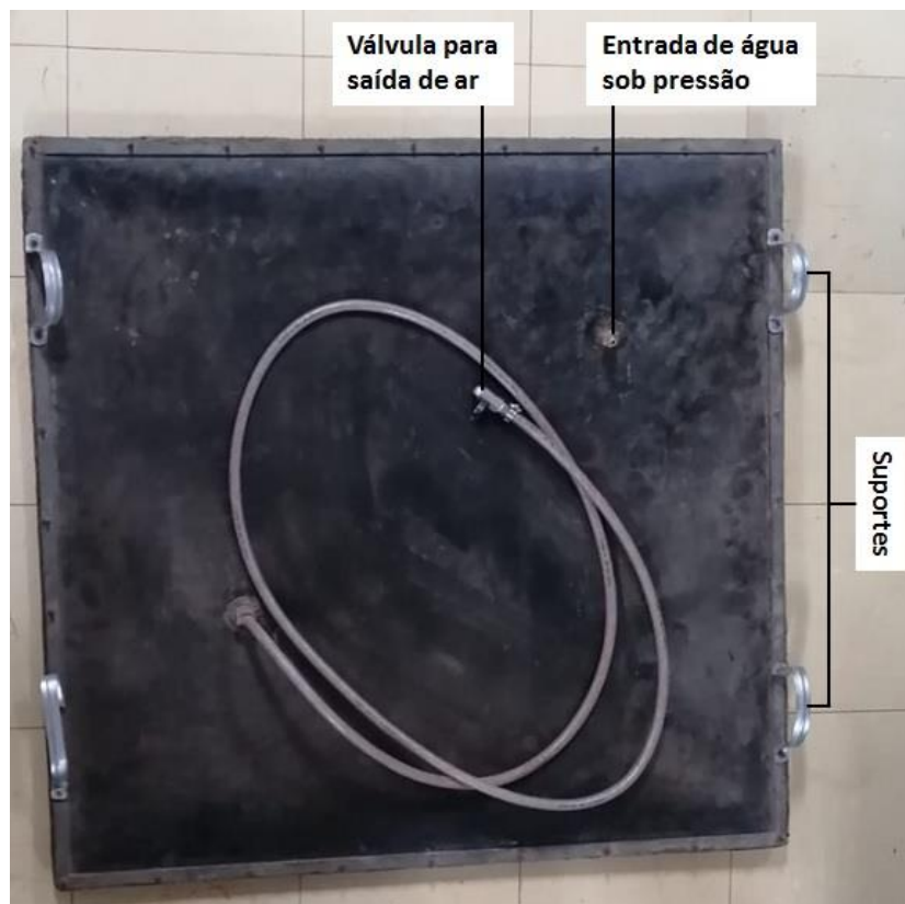
Figura 3.3 – Bolsa de borracha quadrada para aplicação de carregamentos distribuídos na superfície do aterro.
