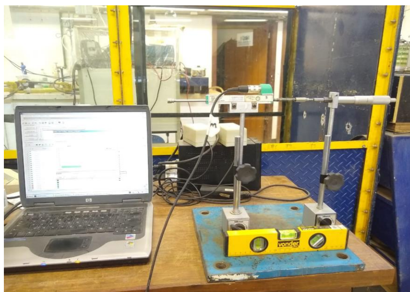
Figura 3.12 – Calibração do LVDT 3 com micrômetro.
