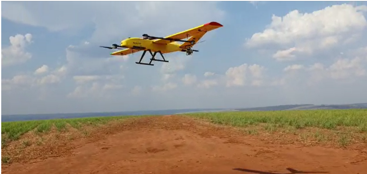
Figura 5.2: SARP NAURU 500C Realizando Manobra de Decolagem Vertical (VTOL).
