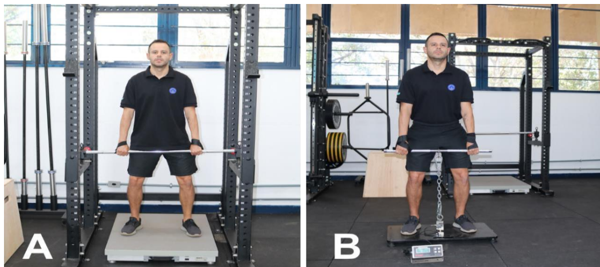
Figura 5. Teste do isometric mid-thigh pull utilizando uma configuração laboratorial, teste critério (A) e uma configuração portátil, teste prático (B).
