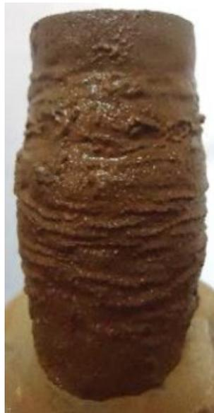
FIGURA 4.18 - Fotografia do resultado do ensaio triaxial não drenado de uma amostra solta (~78%) de rejeitos de flotação (amostra F-B21-385)
