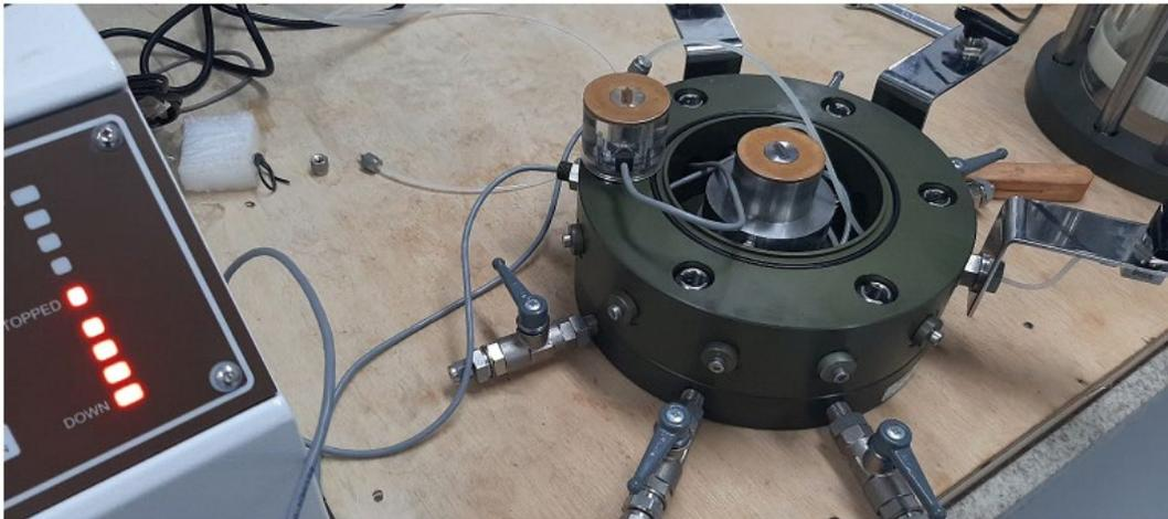
FIGURA 3.8 - A configuração do conjunto de células triaxiais com transdutores BE.
