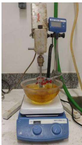
Figura 22. Imagem digital do sistema montado para a reação sem utilização de solvente.
