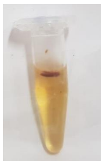
Figura 68. Imagem digital do resultado do teste de solubilidade do Mat_OMaracujá em \text{CHCl}_3 .
