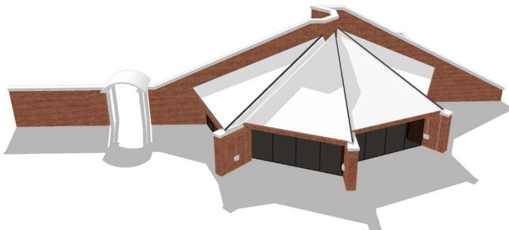
**Figura 164.** Três apoios estruturais e revestidos em tijolos acompanham a dinâmica circular da cobertura. Maquete eletrônica feita pelo autor, 2021.
