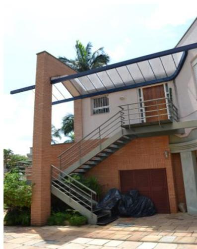
**Figuras 245 e 246.** O enorme paredão de tijolos interrompido pelo rasgo do pórtico que recebe a escada metálica de acesso às dependências do anexo. Fotografias próprias do autor, 2019.
