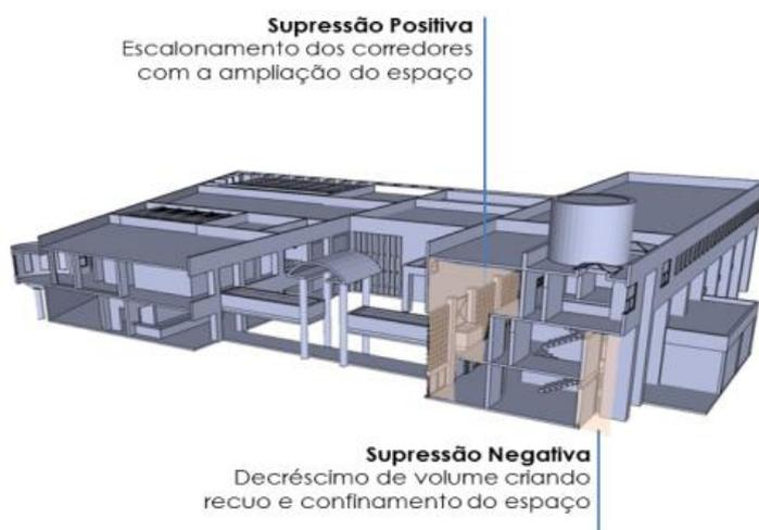
**Figura 442.** Externamente, a leitura do grande volume do bloco 01 deixa claro o formato retangular do edifício. Por dentro, uma sucessão de corredores forma áreas escalonadas, evidenciando o pé direito triplo e ampliando o espaço interno. Essa perspectiva projetual gerou um deslocamento de massa e volume, destacando o grande vazio no interior desse bloco, bastante amplo e aberto. Maquete eletrônica feita pelo autor, 2021.
