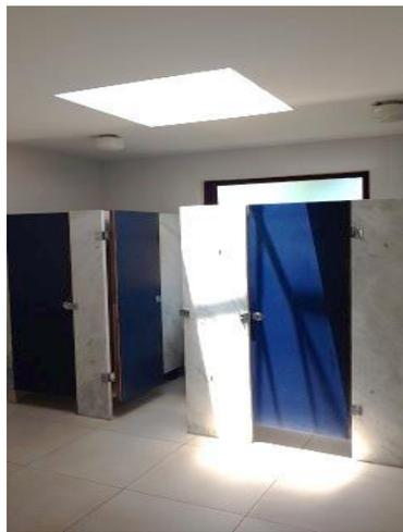
**Figura 439.** A abertura sobre a laje dos banheiros do último andar, um método de iluminação bastante utilizado pelo arquiteto. Fotografias próprias do autor, 2017.
