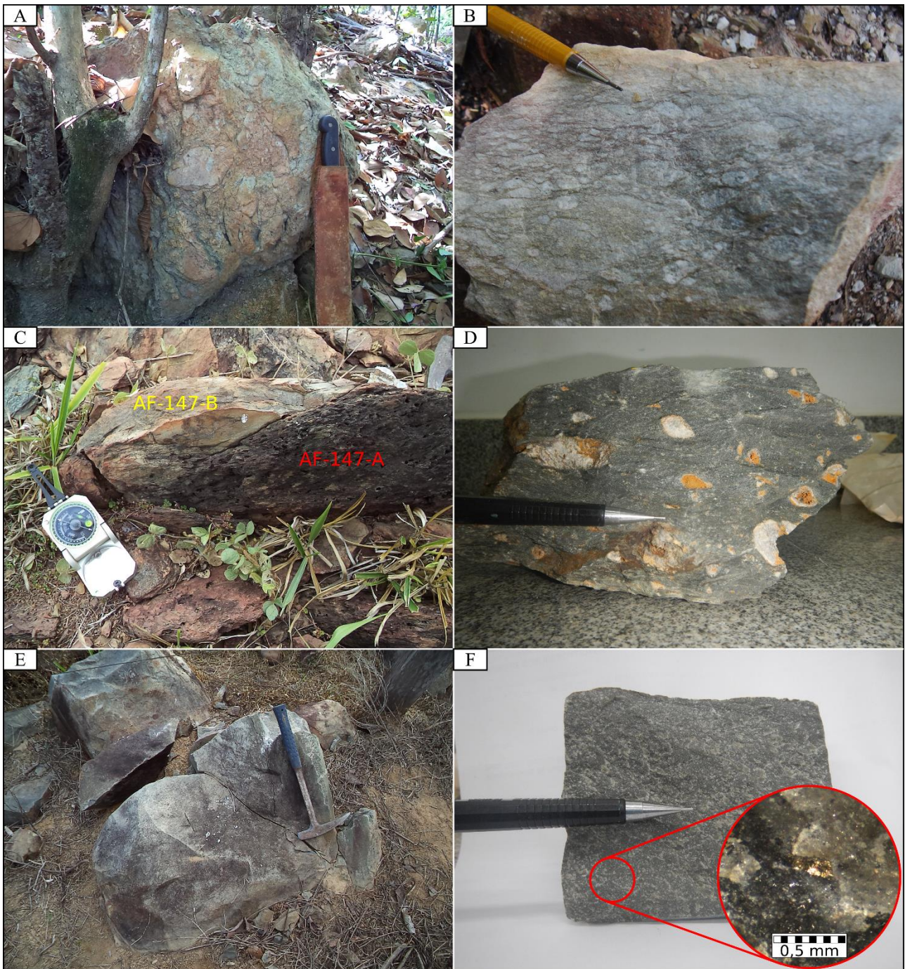
Figura 13: Afloramentos e aspectos macroscópicos das amostras AF-124, AF-147 e DF-182: (A) Afloramento AF-124 mostrando ignimbrito alterado com estrutura de fluxo piroclástico; (B) amostra AF-124 mesmo ignimbrito em uma porção com granulometria média; (C) Afloramento AF-147 mostrando o contato entre a rocha epiclástica (AF-147-A) e a efusiva (AF-147-B); (D) amostra AF-147-A mostrando as vesículas e amígdalas; (E) afloramento DF-182; (F) amostra DF-182 mostrando estrutura maciça e em destaque grão fino de calcopirita.
