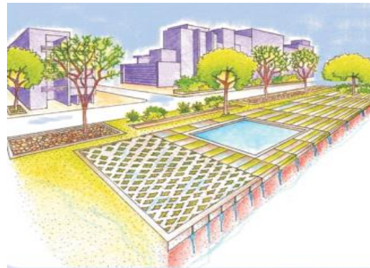
Figura 6: Pavimentos drenantes, CARVALHO (2010)
