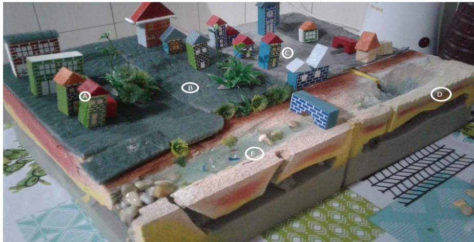
Figura 30 - Disposição de materiais da maquete: (a) bloco de madeira (5cm), (b) superfície permeável com esponja de cozinha (30x 25cm), (c) cobertura impermeável em Tecido de algodão ((30x 25cm), (d) espuma de poliuretano (50x 35x 12 cm), (e) rio de resina epóxi (5x 40cm). Fonte: acervo pessoal da autora.
