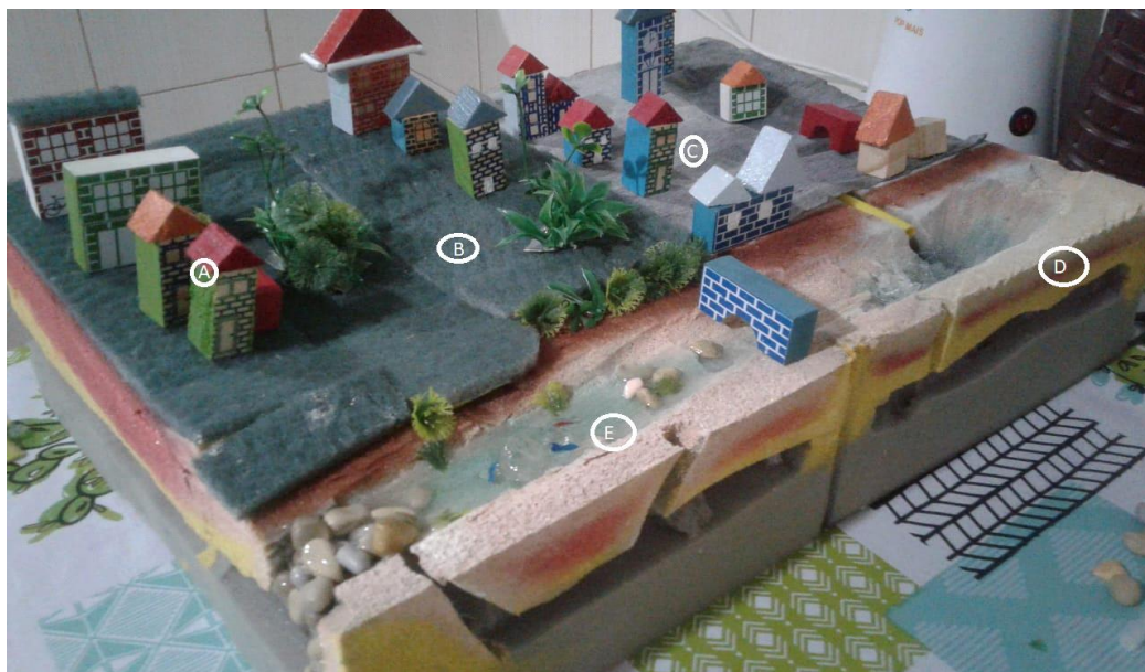
Figura 2 - Disposição de materiais da maquete: (a) bloco de madeira (5cm), (b) superfície permeável com esponja de cozinha (30x 25cm), (c) cobertura impermeável em Tecido de algodão ((30x 25cm), (d) espuma de poliuretano (50x 35x 12 cm), (e) rio de resina epóxi (5x 40cm). Fonte: acervo pessoal da autora.
