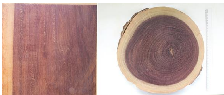
Figura 21: Imagens do corte tangencial e transversal da madeira de Chapada
