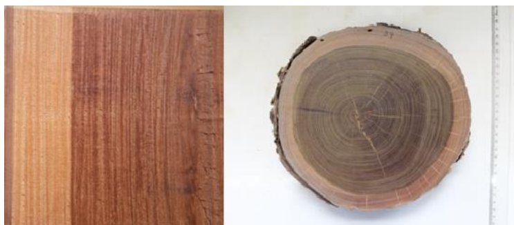
Figura 25: Imagens do corte tangencial e transversal da madeira de Ipê Roxo
