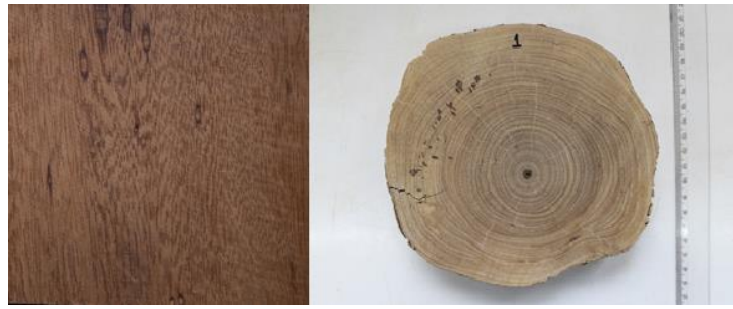
Figura 35: Imagens do corte tangencial e transversal da madeira de Sipaúba
