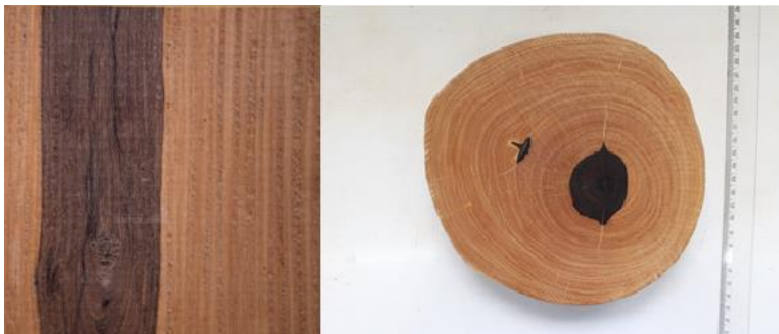
Figura 27: Imagens do corte tangencial e transversal da madeira de Jacarandá de Sangue
