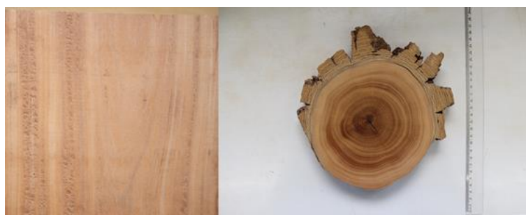
Figura 31: Imagens do corte tangencial e transversal da madeira de Coração de Negro
