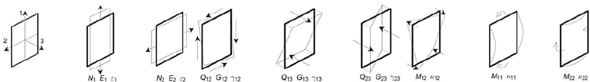
Figura 25 - Elemento tipo placa (Plaxis). (Oliveira, 2015)
