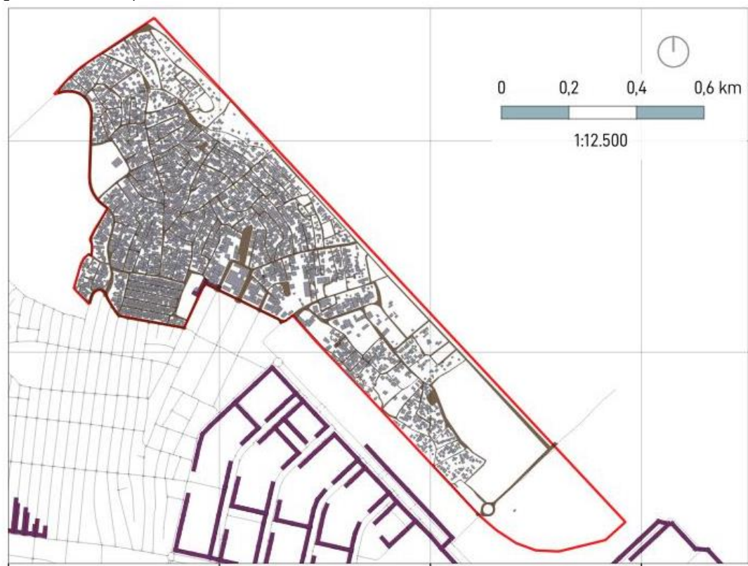
Figura 68 – Tubulações de coleta de efluentes
