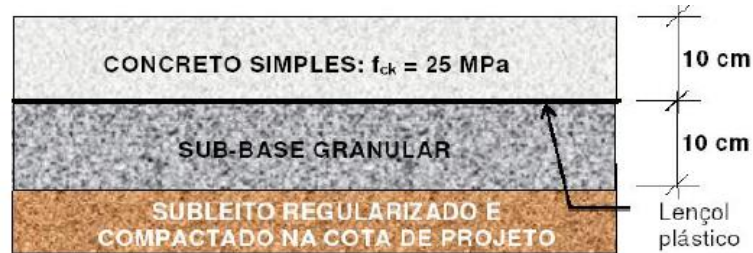
Figura 7 - Esquema das camadas da ciclovia proposto pela ABCP
