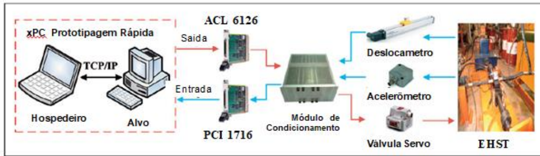
Figura 2.17 Esquema de controle da arquitetura do sistema de hardware. Fonte: (Tang et al., 2016).
