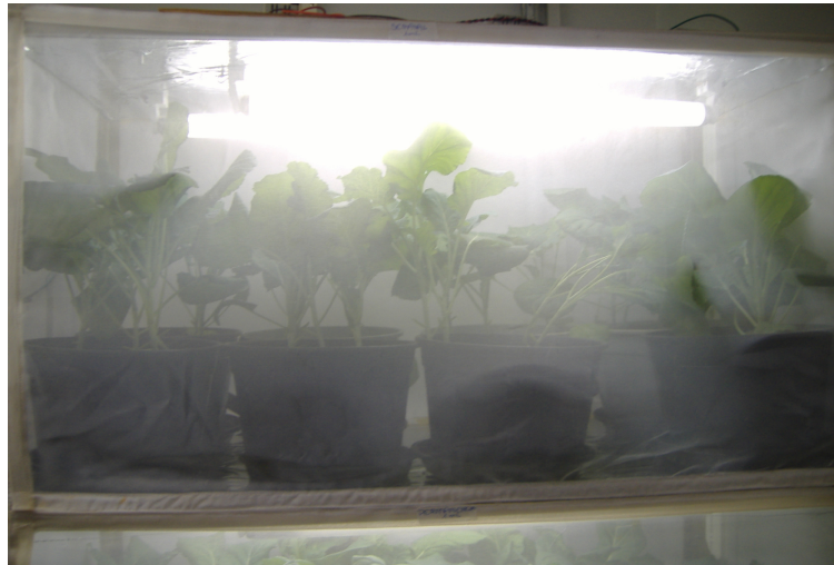
Figura 7-Plantas em estantes protegidas por telas e com fotoperíodo controlado.
