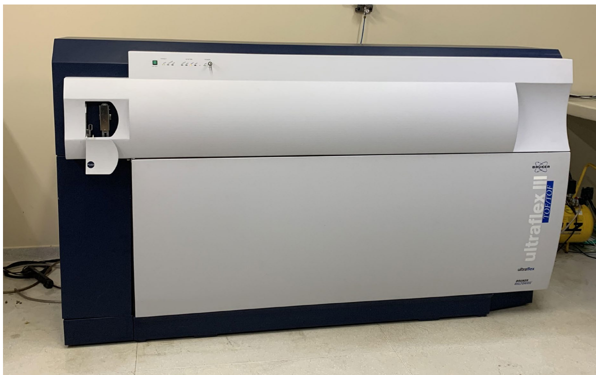
Figura 13. Espectrômetro de massa MALDI-TOF/TOF-MS (time-of-flight) utilizado para as aquisições desta tese. Fonte: Embrapa-Cenargem, Laboratório de Espectrometria de massas.
