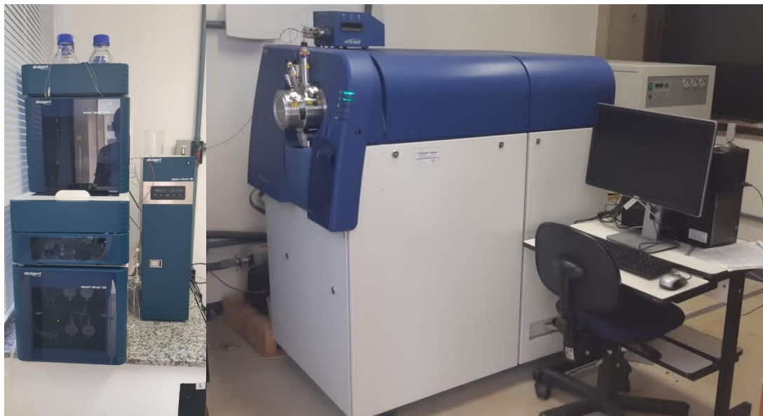
Figura 15. Cromatógrafo RPLC Eksigent UltraLC 110-XL (AB Sciex) acoplado a um espectrômetro de massa TripleTof 5600+ (AB Sciex) utilizados para as aquisições desta tese. Fonte: Instituto de Química, Universidade de Brasília (UnB), Laboratório de Análise e Síntese de Moléculas (LITMO).
