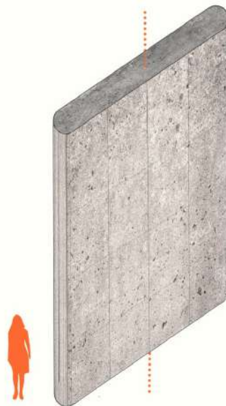
Figura 176 - Volumetria do novo pilar em formato capsular 50x400 cm, OAE 01, TTNN, Brasília, DF. Fonte: autoral
