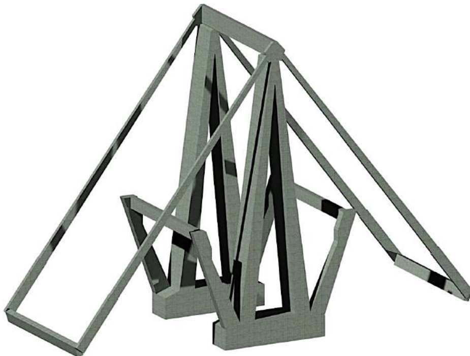
Figura 280 – A. Cavalete de madeira. Mastro da Ponte Morandi, conceituado na forma de “cavalete”. Fonte: autoral
