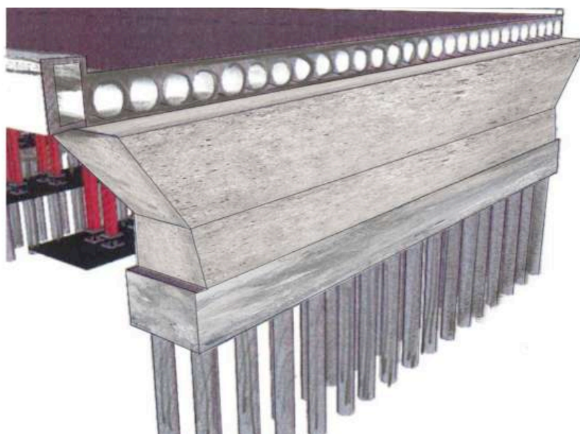
Figura 149 - Novas fundações e reforço do pilar original, Fonte: Proposta de recuperação do Viaduto sobre a Galeria dos estados da DER/DF e NOVACAP (2018)
