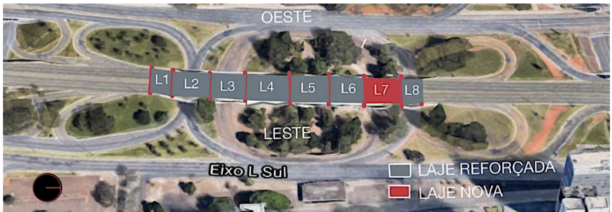
Figura 114 - Mapeamento lajes do Viaduto sobre a Galeria dos Estados, Fonte: Adaptado de Google Earth
