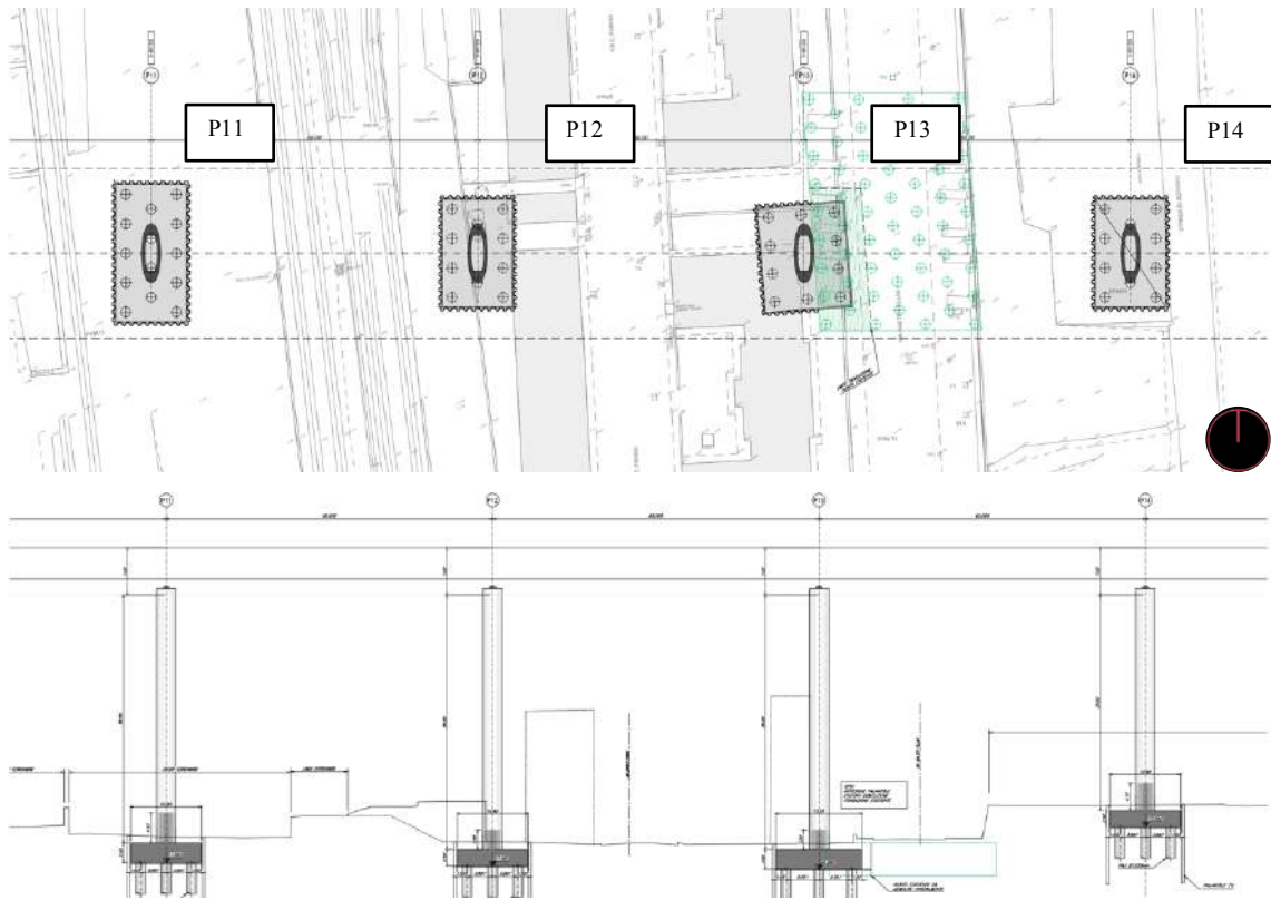
Figura 307 - Planta e elevação lateral dos pilares elípticos P11, P12, P13, P14 e respectivas fundações. Fonte: Adaptada de ITALFERR
