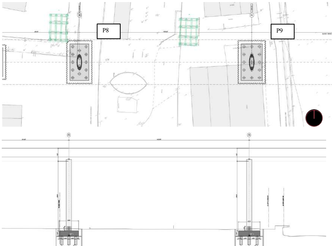
Figura 305 - Planta e elevação lateral dos pilares elípticos P8, P9 e respectivas fundações. Fonte: Adaptada de ITALFERR
