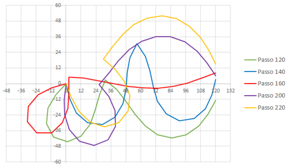
Figura 5-10: Deformada para o elemento EBNL - Passos 120 a 220
