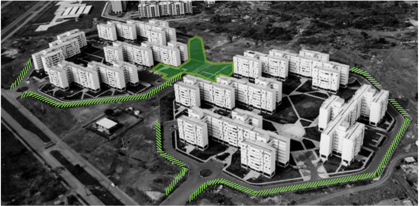
fig. 17 Elvin optou por concentrar as circulações de pedestres dentro do octógono menor, onde estão os edifícios. No octógono maior vemos as vias de conexão dos estacionamentos de visitantes e das entradas de garagens vinculadas aos edifícios. Externamente a essa existe o cinturão verde .
