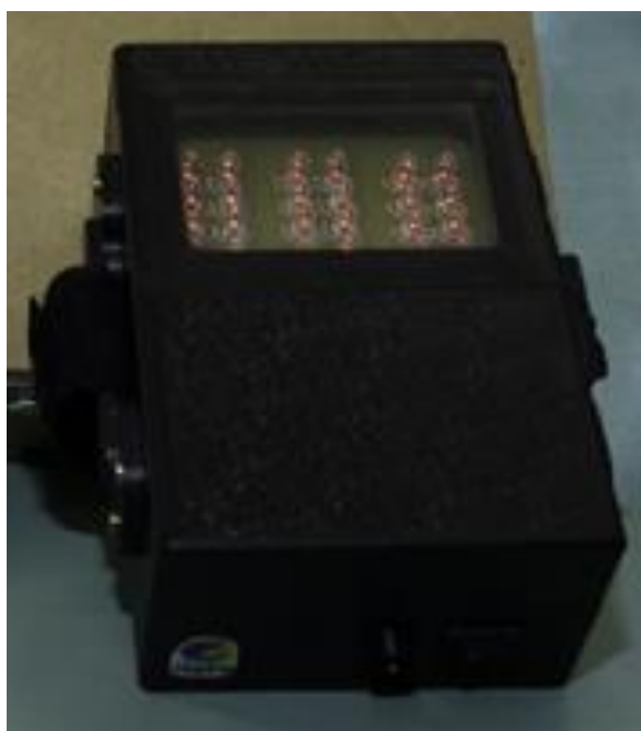
Figura 16. Equipamento de neoformação tecidual com LED de alta potência com comprimento de onda entre 635 e 640 nm (luz vermelha) RAPHA®. Fonte: O autor, 2020.
