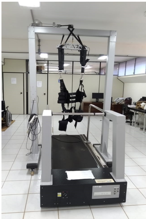
Figura 6. Esteira computadorizada (TK35, Cefise, Brasil), trave de suspensão com colete e o motor elétrico.
