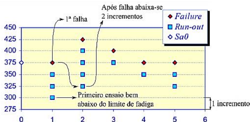
Figura 30 – Exemplo didático de experimento do método da escada modificado [73].
