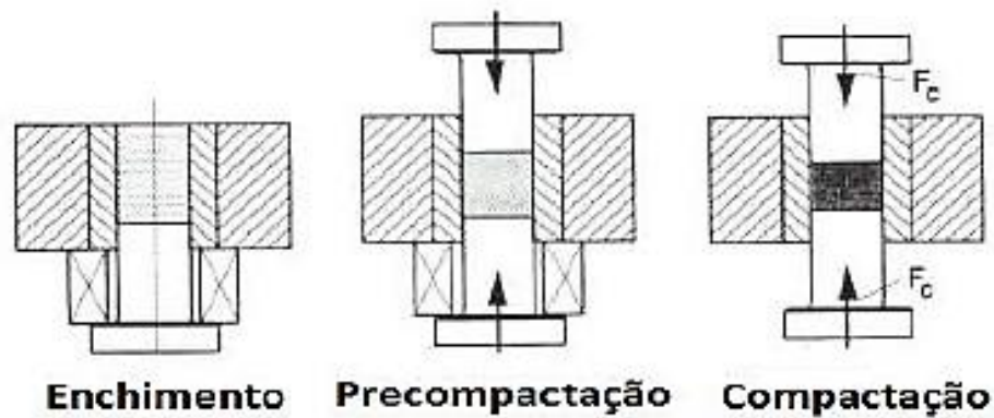
Figura 36 - Prensagem uniaxial do pó cerâmico [47].
