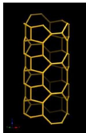
Figura 14: Canal 1 indicado na figura 13 visto ao longo do eixo z, mostrando a cavidade em sua extensão. Reproduzido de [47].
