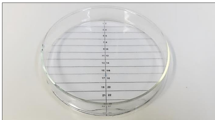
Figura 10. Placa de petri e papel numerado utilizado para contagem de quitinozoários em meio aquoso. Diâmetro da placa de petri =10 cm.
