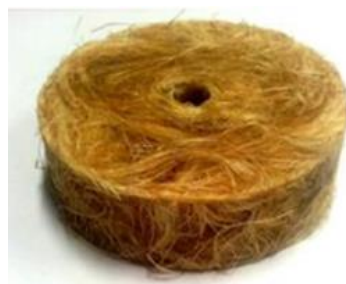
(e) Distanciador com fibra de sisal pronto para uso
