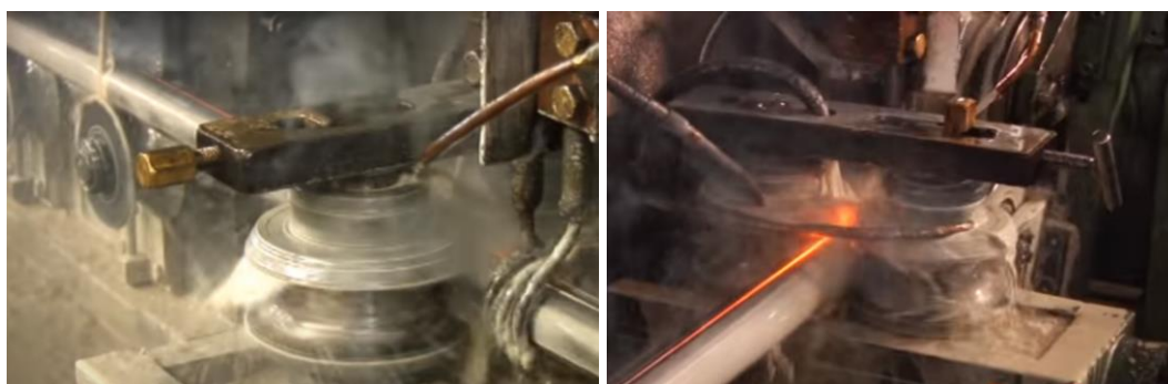
Conformação da chapa em tubo redondo na máquina de trefilação
