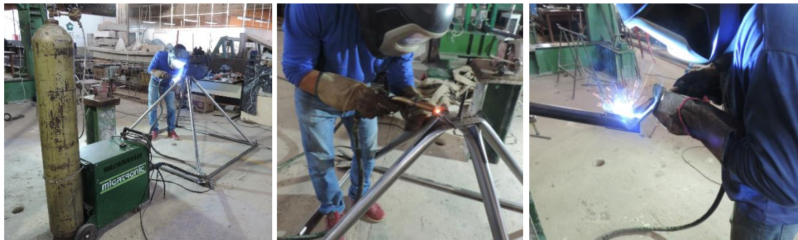
(b) Processo de soldagem das diagonais
