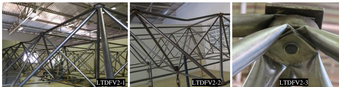
(b) Colapso do protótipo LTDFV2
