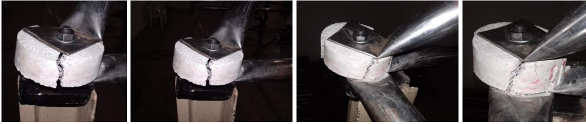
(i) Falha dos distanciadores no apoio da treliça tridimensional na coluna metálica
