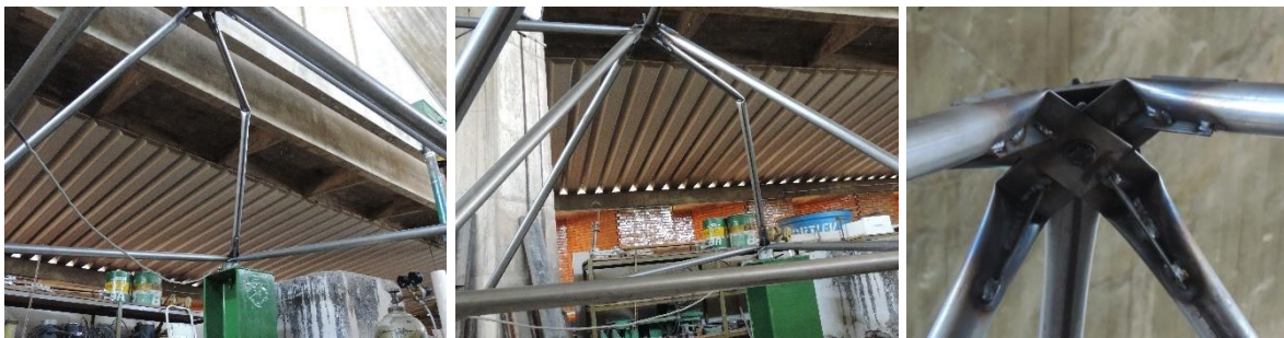
(c) Ruptura da diagonal sem ocorrer falha na ligação típica LTCR1
