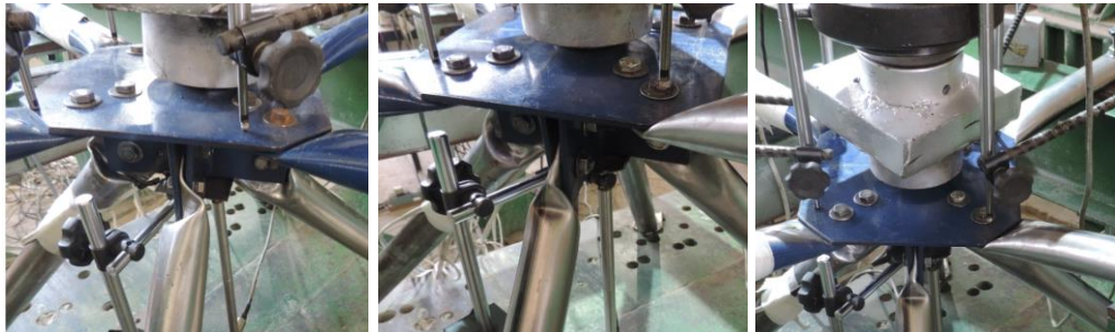
(a) Modos de colapso das três ligações LTECA
