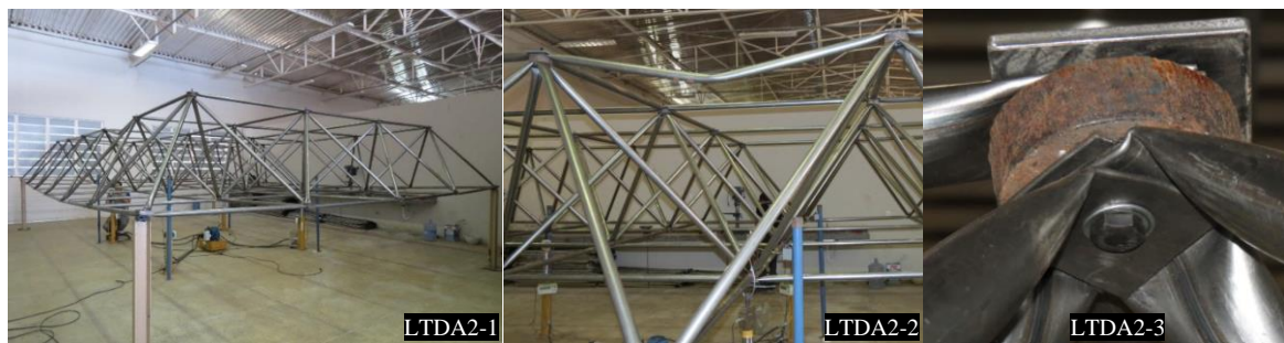
(b) Detalhe do modo de colapso do protótipo LTDA2
