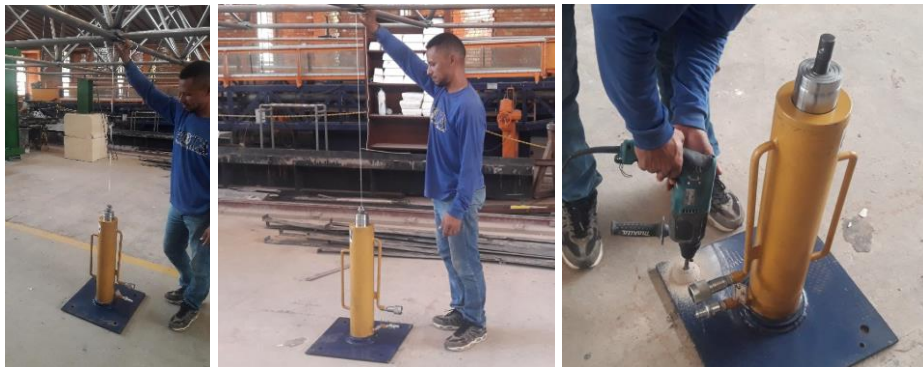
(b) Posicionamento dos atuadores hidráulicos e fixação no piso do laboratório
