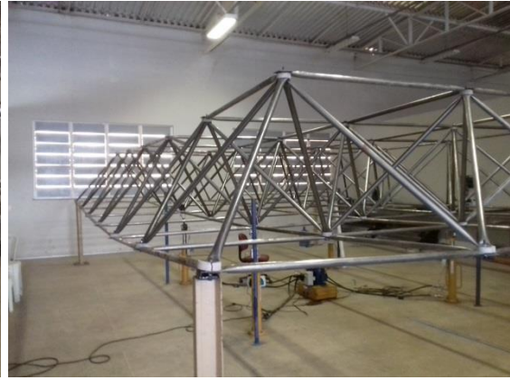
(e) Estrutura após o ensaio destrutivo
