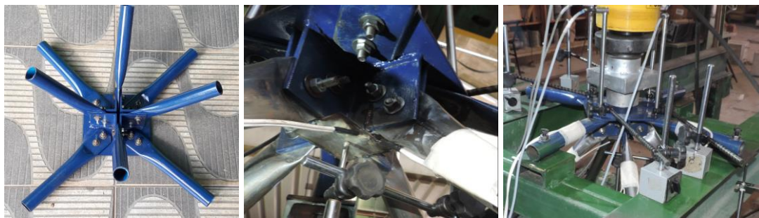
(a) Ensaio da L igação T ípica com extremidade E stampada com C hapas de A ço – LTECA
