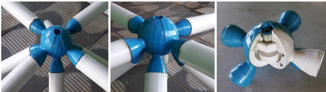
(l) Ligação impressa por meio de impressora 3D com montagem usando tubos de PVC de 40,00 mm de diâmetro
