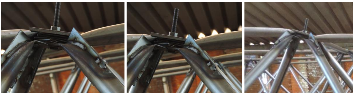
(g) Ligações típicas LTCR2 com rotação nas ligações intermediárias
