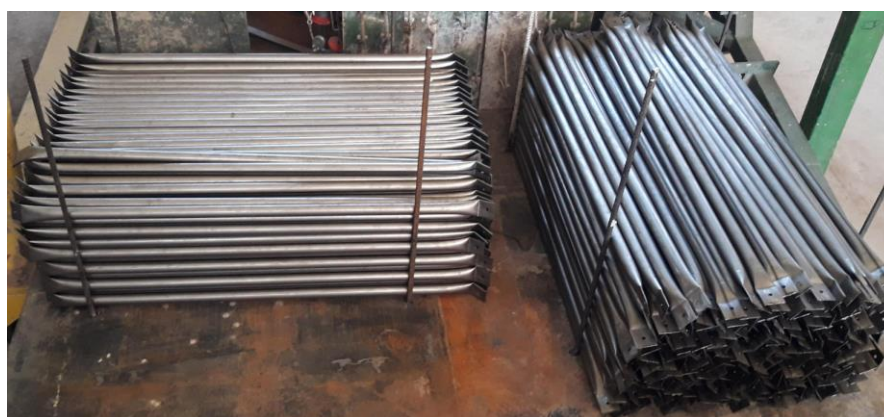
(e) Barras prontas para execução da montagem das treliças tridimensionais
