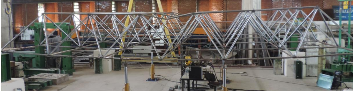
(a) Primeiro ensaio com LTDCEA1 com ruptura da barra do banzo comprimido
