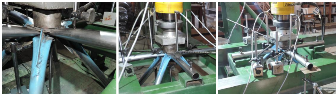
(e) Ensaio da Ligação Típica com Chapa Reentrante – LTCR
