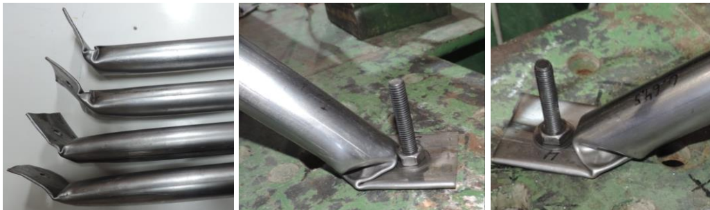
(b) Falha das extremidades das barras das diagonais
