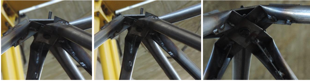
(b) A chapa reentrante não permitiu que houve rotação da seção estampada LTCR1
