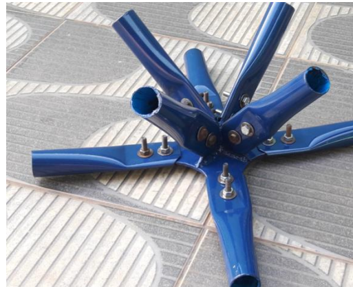
(j) Ligação Típica com dispositivo de chapa de aço Modelo 4- Combinação Sistema b 4
