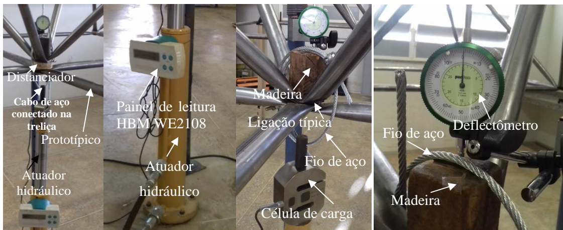
(a) Detalhe do sistema de aquisição de dados com célula de carga e Deflectômetro
