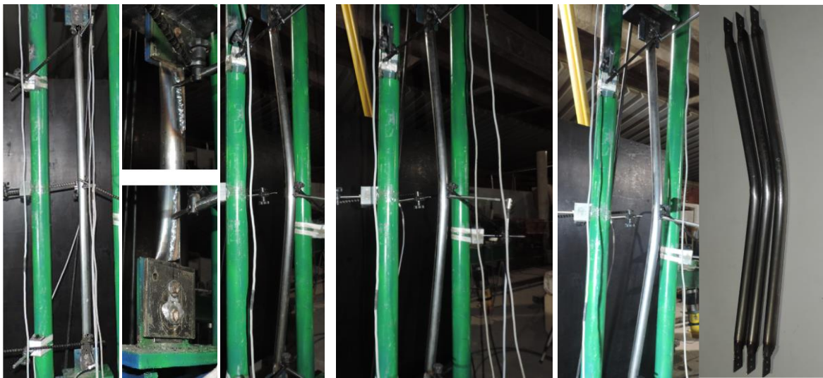
(v) Modos de colapso dos espécimes BCR1325 com índice de esbeltez \lambda = 100
