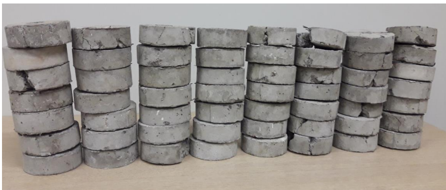
(l) Os 56 distanciadores de concreto com fibra de aço após o ensaio do protótipo LTDCFA
