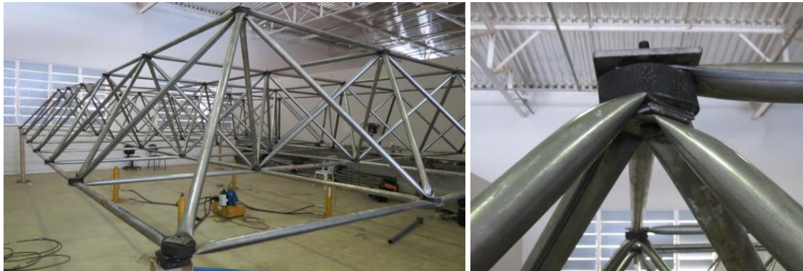
(c) Ruptura do protótipo LTDP2 e detalhe do distanciador de pneu na ligação
