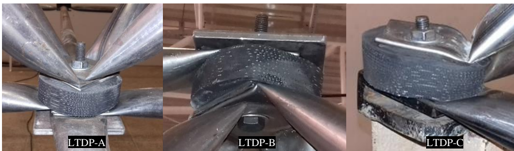
(g) Distanciadores na ligação central e um na ligação de extremidade da treliça
