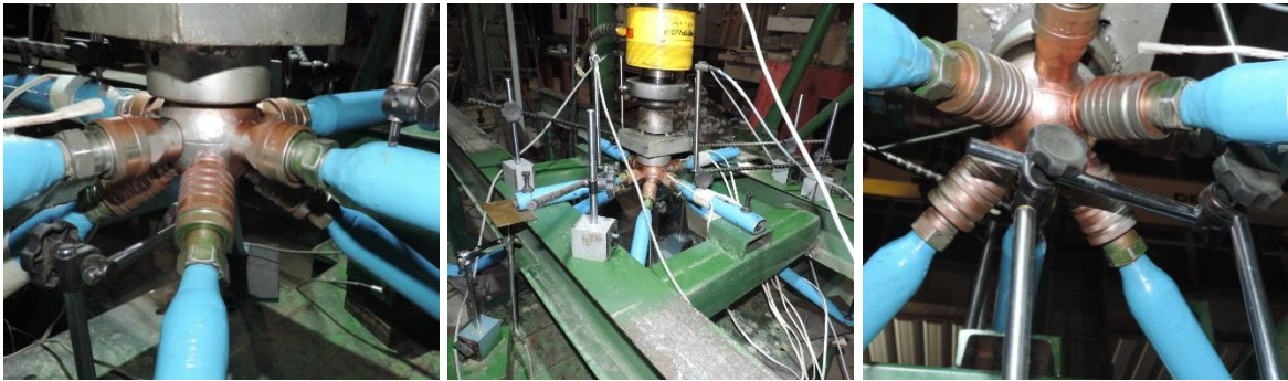
(d) Primeira ligação (bronze) na posição de ensaio
