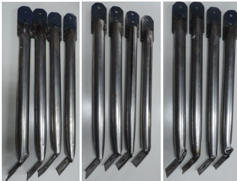
(b) modos de falha das extremidades das diagonais da ligação LTPCA
