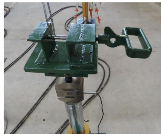
(c) Mecanismo com a vareta interna
