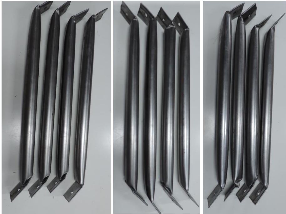
(e) Detalhe da ruptura das extremidades das barras das diagonais
