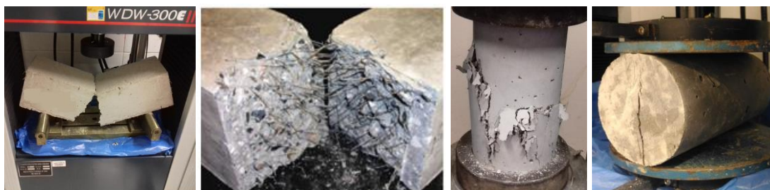
(a) Ruptura da viga de concreto com fibra de aço (b) Ruptura no teste à compressão (c) Ruptura diametral
