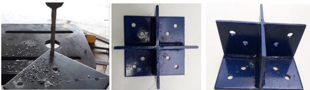
(b) Ligação LTPCA com chapas de aço ASTM A36 com espessura de 5 mm
