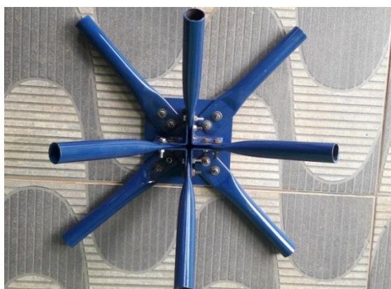
(h) Ligação Típica com dispositivo de chapa de aço Modelo 2- Combinação Sistema b_2
