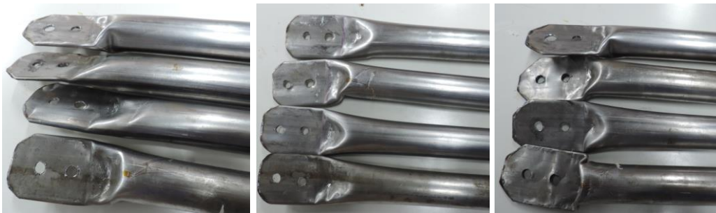
(b) Extremidade das barras parafusadas na ligação de aço
