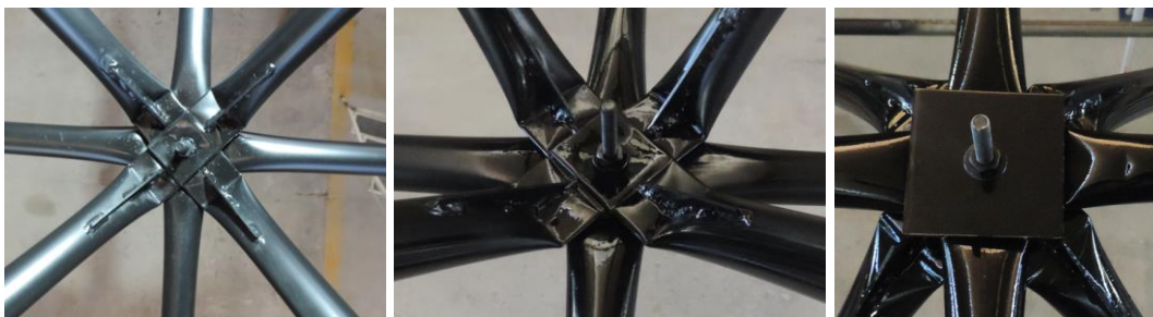
(g) Chapa reentrante da conexão típica LTCRE
