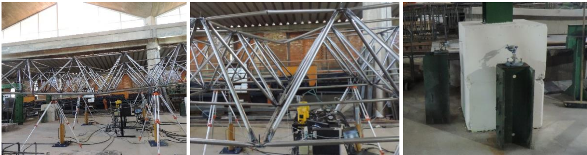
(k) Vista frontal do protótipo LTCR2 e vista do bloco com os deflectômetros
