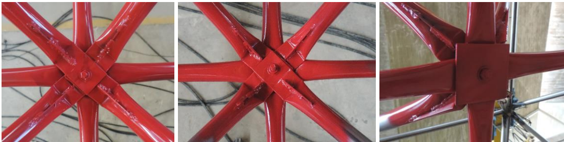
(e) Vista superior e inferior da ligação LTCRE
