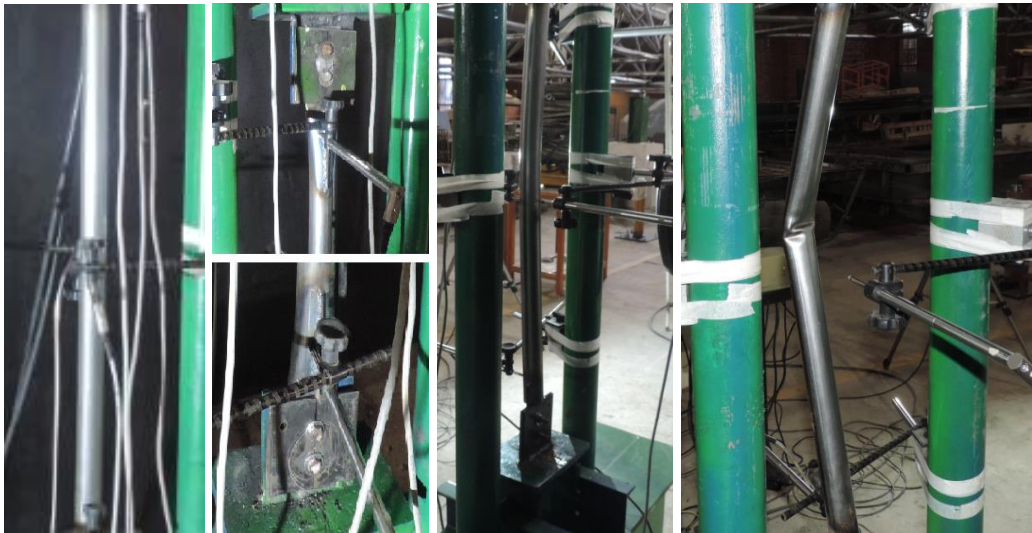
(m) Modos de colapso dos espécimes BCR915 com índice de esbeltez \lambda = 70
