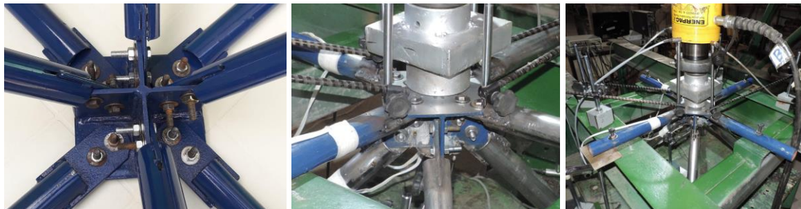
(b) Ensaio de L igação T ípica com P onteira usando ligação de C hapa de A ço – LTPCA
