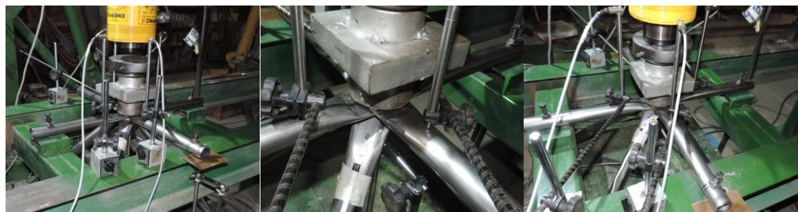
(c) Ensaio da L igação T ípica com extremidade E stampada – LTE
