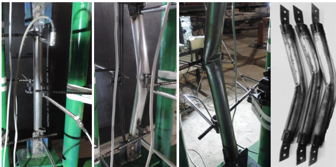
(k) Modos de colapso dos espécimes BCG800 com índice de esbeltez \lambda = 60
