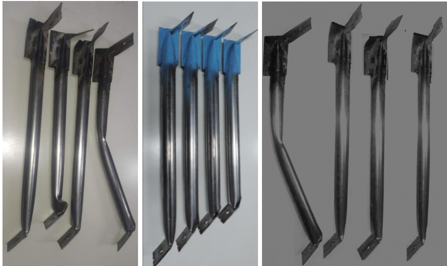
(d) Barras das diagonais dos três ensaios LTQR
