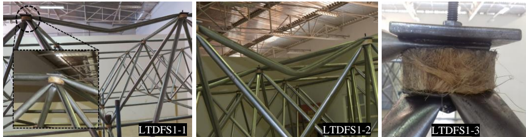
(a) Modos de colapso do protótipo LTDFS1
