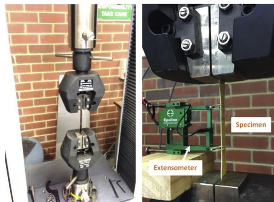
Figura 10.2 – Ensaio de tração e módulo de elasticidade da fibra de vidro embebida em resina de epóxi (Chen et al. , 2017)
