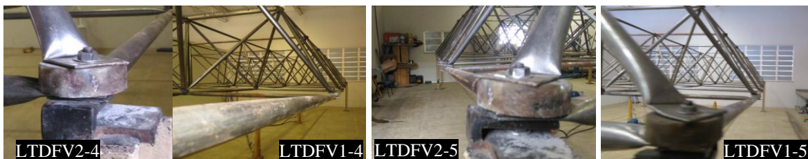
(d) Flecha dos protótipos após ensaio de força axial de compressão estático
