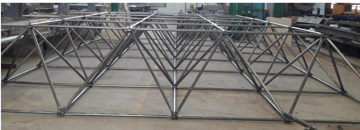
(b) Protótipo LTDCEA montada no piso do laboratório
