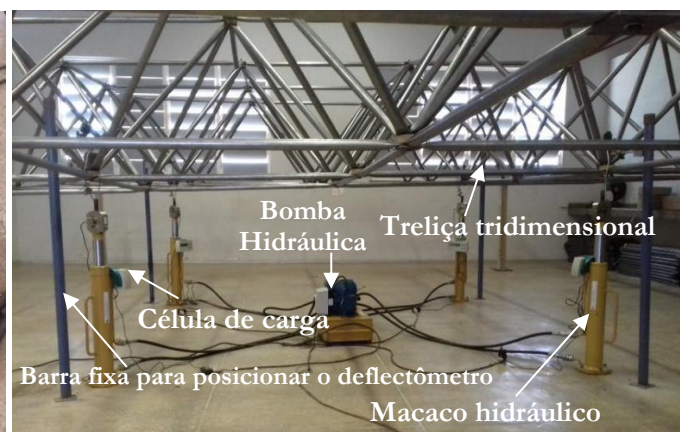
(c) Sistema para o teste estrutural
