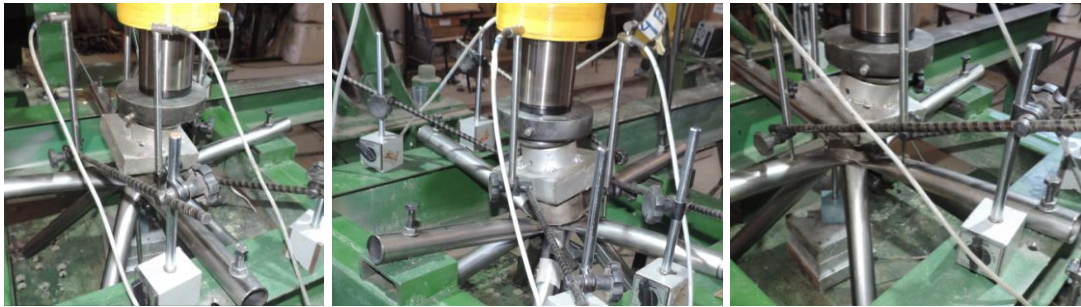
(a) Colapso da ligação típica com rotação devido a excentricidade e falha da barra DS4
