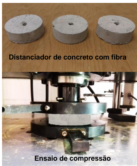
(e) Ensaio de compressão com distanciador de concreto com fibra de aço -TCFA
