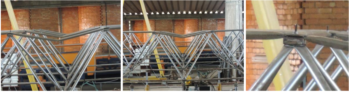
(e) Diferentes vistas dos banzos superiores do protótipo LTDCEA1
