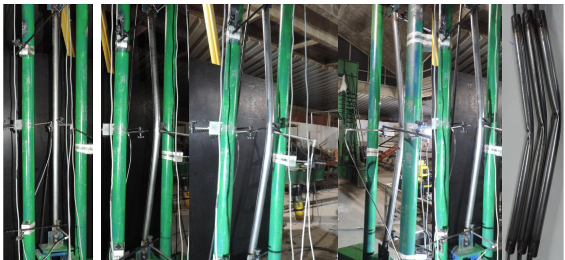
(w) Modos de colapso dos espécimes BCG1325 com índice de esbeltez \lambda = 100
