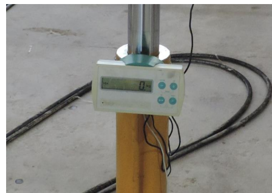
(e) Painel para leitura da célula de carga
