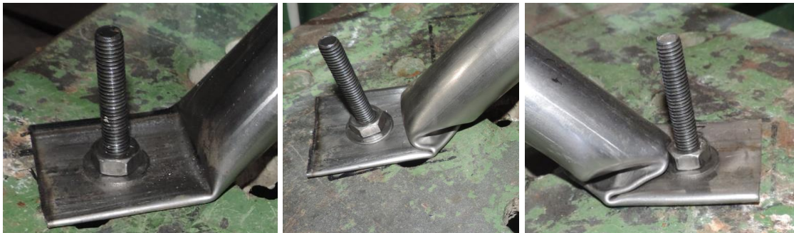
(c) Vista antes e depois do esmagamento das extremidades das barras
