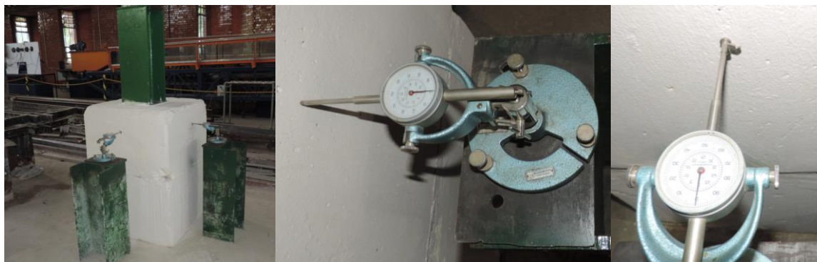
(k) Deflectômetros posicionados para verificar possíveis deslocamentos dos blocos
