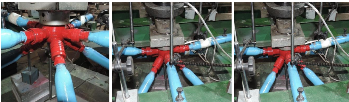
(e) Segunda ligação (vermelha) sendo ensaiada com carregamento estático
