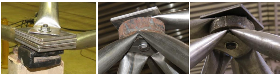
(c) Detalhe das duas extremidades das barras do LTDA1 e ligação da LTDA2
