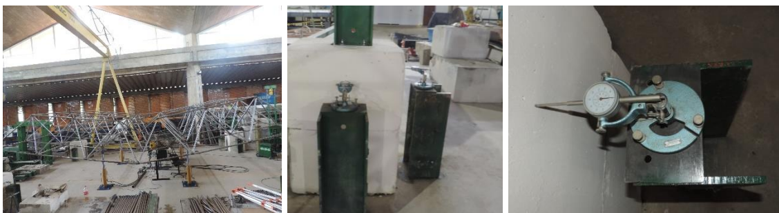
(j) Visão geral do ensaio e detalha do deflectômetro no bloco que não apresentou nenhum deslocamento durante os ensaios experimentais
