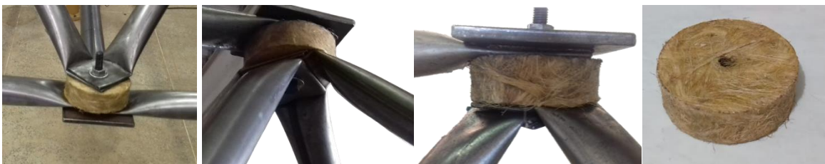
(b) Distanciador de fibra de sisal usado nos dois protótipos sem sinais de ruptura
