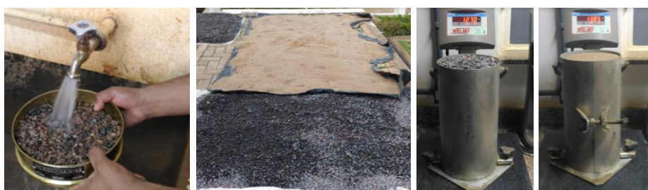
(a) Etapas de lavagem (b) Secagem dos agregados (c) Pesagem dos materiais
