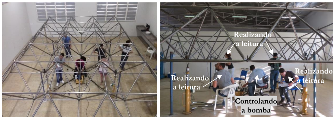
(j) Realização das leituras de força vs. deslocamento durante o ensaio experimental
