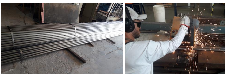
(a) Corte das barras com comprimento 1500 mm
