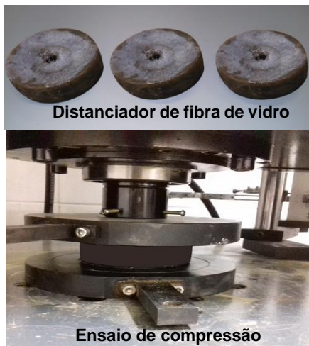
(c) Ensaio de compressão com distanciador de fibra de vidro -TDFV
