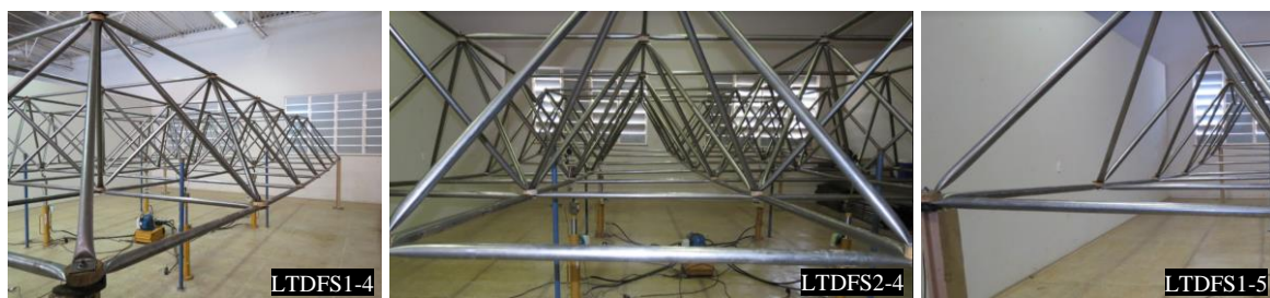
(d) Flecha dos protótipos após colapso da estrutura
