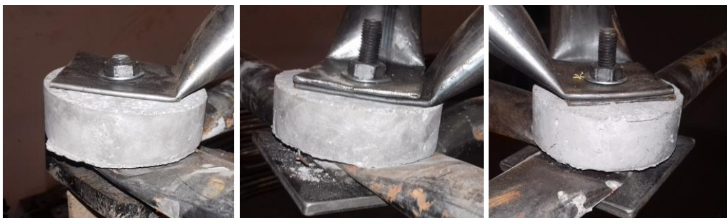
(c) Distanciadores nas ligações de apoio e extremidade do protótipo LTDCFA
