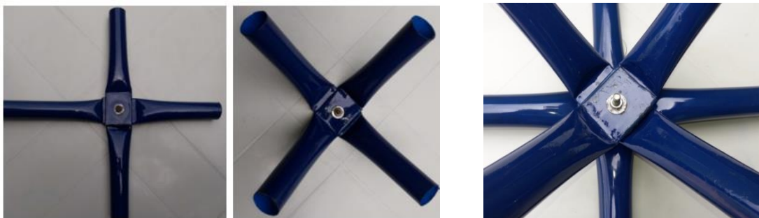
(a) Banzo e diagonal da ligação
