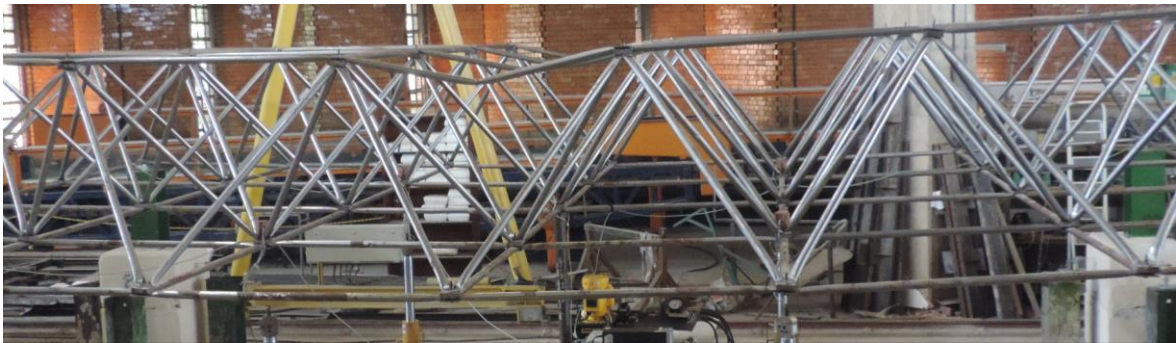
(f) Vista com identificação das barras que romperam por instabilidade
