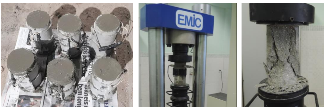
(a) Concretagem com SikaGraut® (b) Ensaio de módulo (c) Modo de Ruptura
