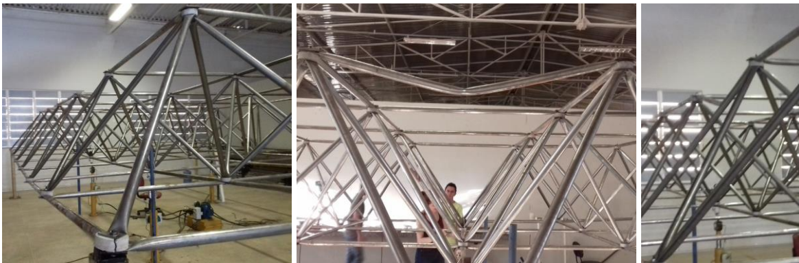
(f) Detalhes da ruptura do protótipo LTDCFA por instabilidade das barras comprimidas
