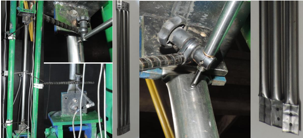
(u) Modos de colapso dos espécimes EBE1325 com índice de esbeltez \lambda = 100
