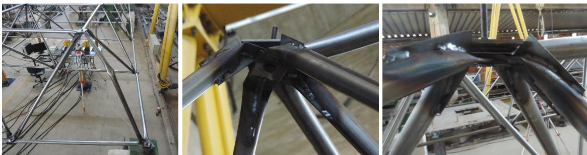
(a) Vista do colapso da diagonal do apoio, mas a ligação típica não apresentou rotação na seção mostrando que o reforço com a chapa reentrante conseguiu evitar a rotação da ligação típica, no ensaio LTCR1
