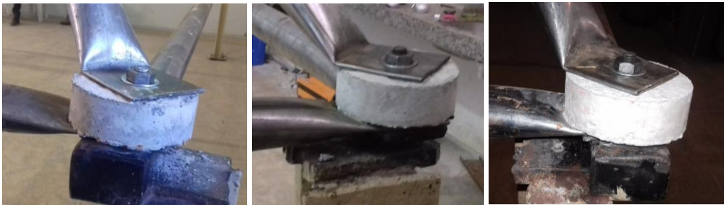
(a) Distanciadores de concreto com fibra antes do ensaio do protótipo LTDCFA
