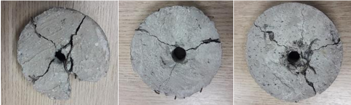
(j) Detalhe das trincas no distanciador de concreto com fibra de aço após o ensaio
