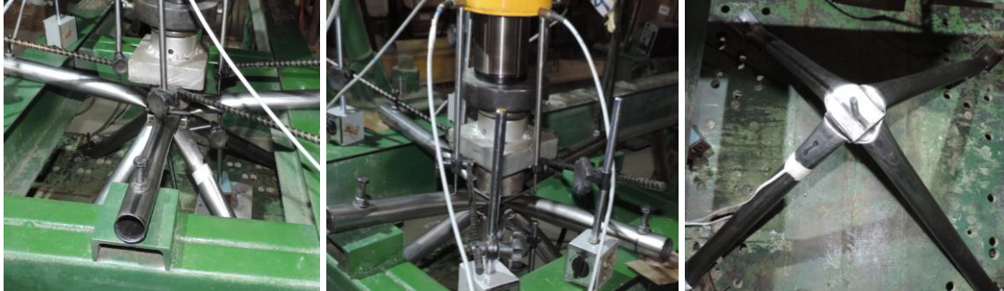
(a) Vista dos espécimes após a falha com amassamento nas duas extremidades da barra
