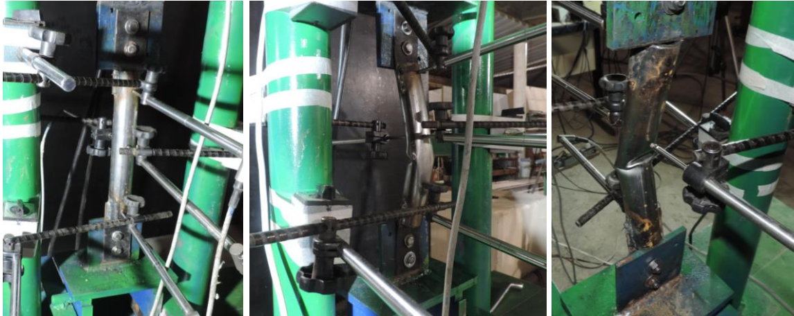
(d) Modos de colapso dos espécimes BCG250 com índice de esbeltez \lambda = 20
