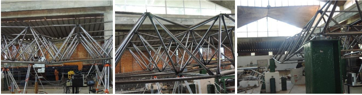
(j) Vista lateral dos modos de colapso e vista da flecha devido o colapso da LTCR2
