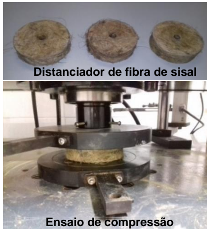
(b) Ensaio de compressão com distanciador de fibra de sisal -TDFS
