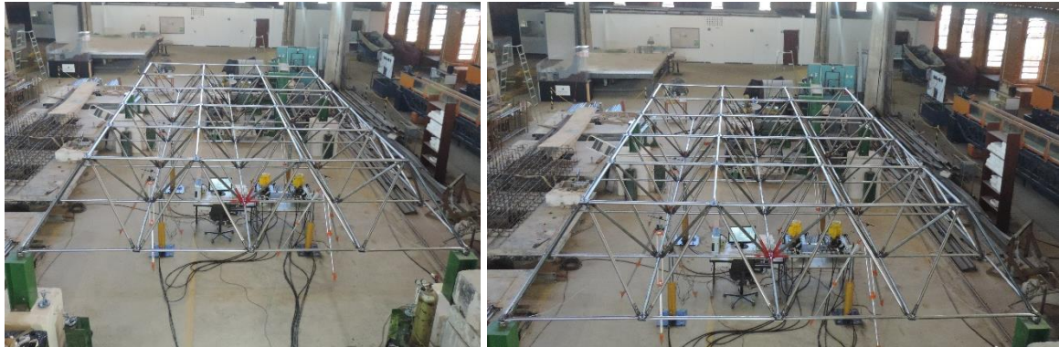
(i) Protótipo LTCRE na posição de ensaio
