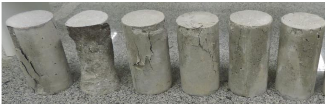
(d) Modos de ruptura dos seis corpos-de-prova
