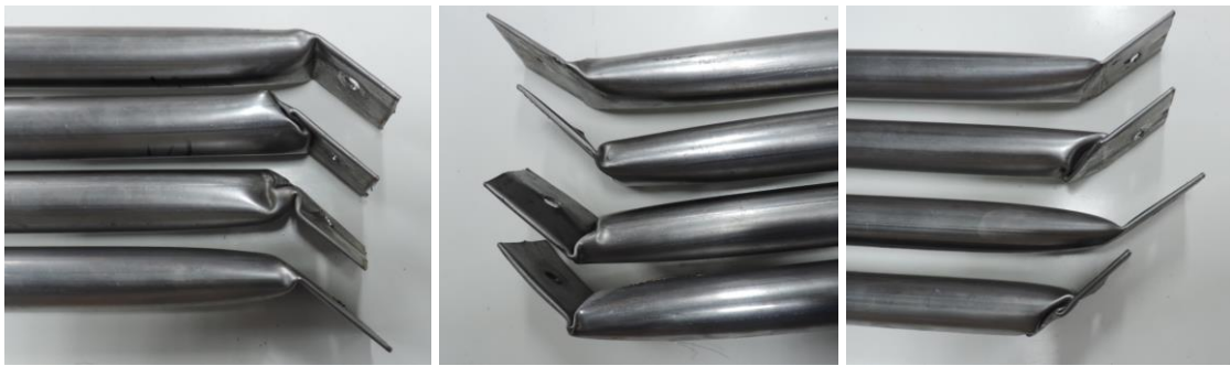
(b) Ruptura das extremidades das barras
