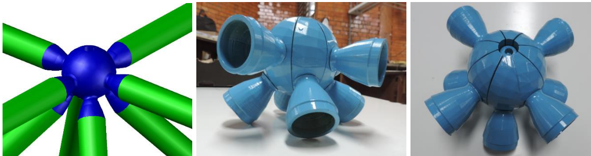
(k) Ligação completa para treliça tridimensional de camada dupla
