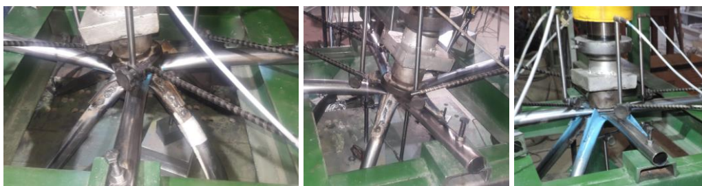
(a) Modos de ruptura das ligações LTRC nos três ensaios
