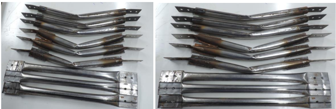
(g) Modos de falha dos espécimes \lambda = 40 (h) Modos de falha dos espécimes \lambda = 50
