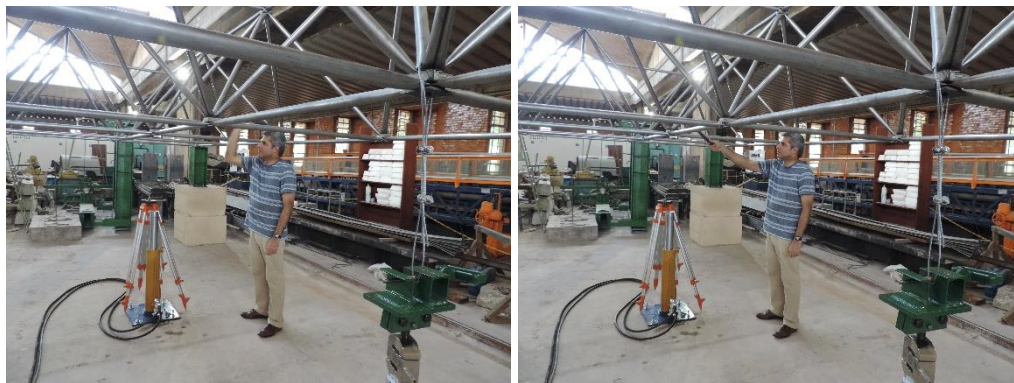
(b) Metodologia da excitação da estrutura com martelo de impacto
