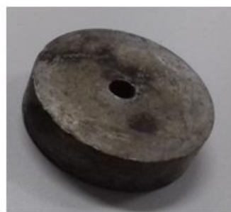
(b) Distanciador de aço com diâmetro de 80 mm e altura de 22 mm e furo de 11 mm
