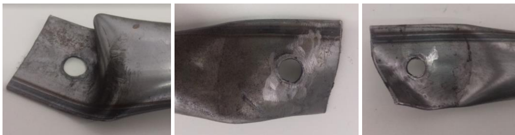
(c) Extremidade da barra estampada do protótipo com LTI1
