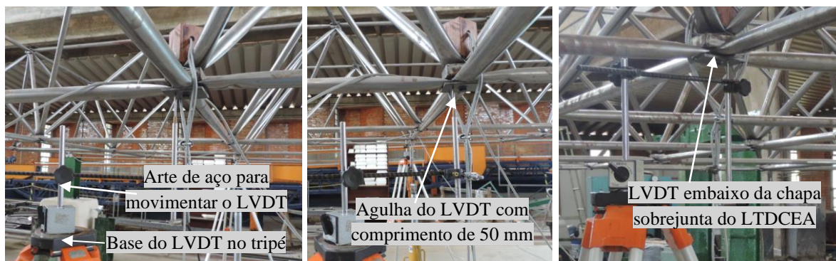
(g) Posicionamento dos LVDT's nas ligações típicas para leitura dos deslocamentos
