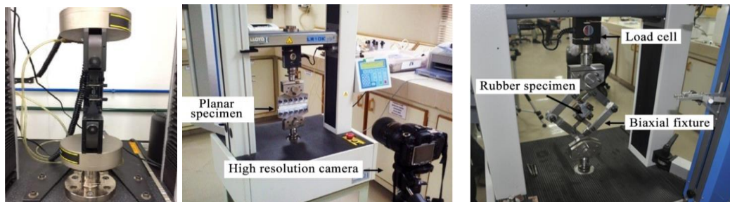
Figura 10.3 – Configuração para medições de deformações e teste de equipamento à produzir tensões biaxiais em espécime de borracha (Shahzad et al. , 2015) e (Paula, Lalo e Greco, 2013)
