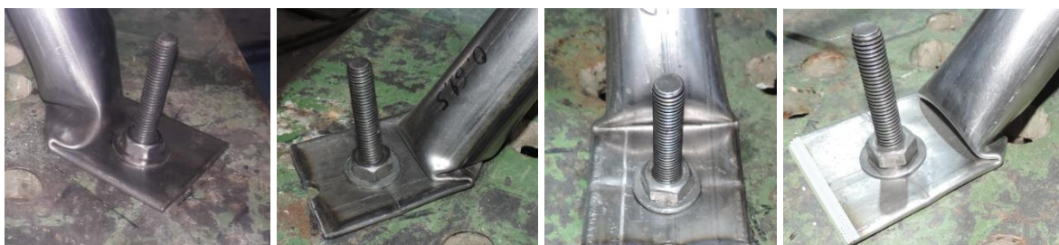
(b) Esmagamento da extremidade das quatro barras de apoio das diagonais
