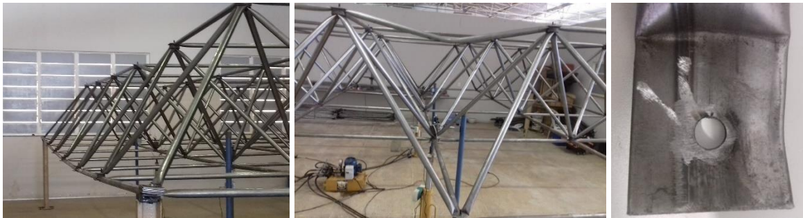
(a) Modos de colapso do protótipo LTDA2 e detalhe da extremidade da barra que rompeu
