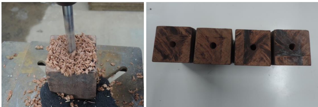
(c) Execução do furo na madeira angelim para encaixe no parafuso da ligação
