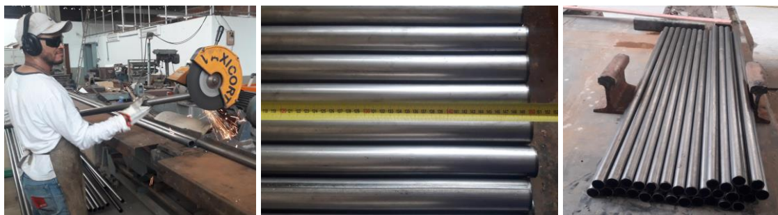
(b) Acabamento na extremidade das barras e armazenamento
