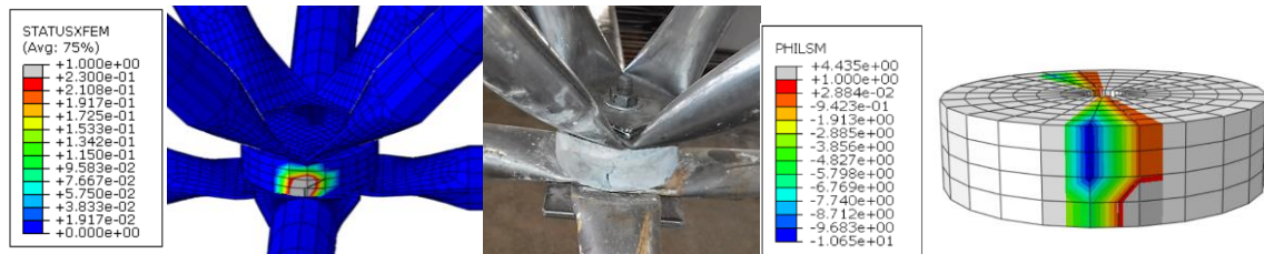
(b) Distanciador de concreto da ligação central frente ao modelo experimental
