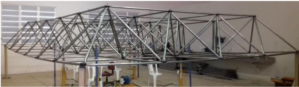
(b) Protótipo LTDP1 após o ensaio com ruptura da barra comprimida por instabilidade
