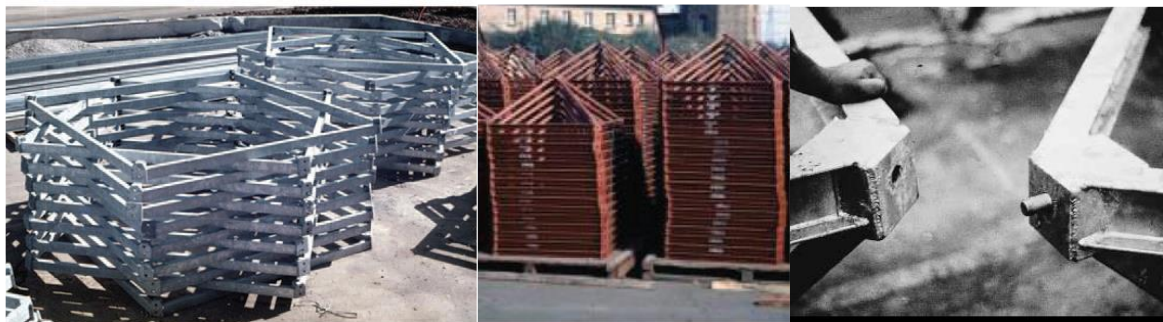
Figura 2.24 – Pré-fabricação do sistema UNIBAT de Du Château (Tarczewski e Motro, 2015)
