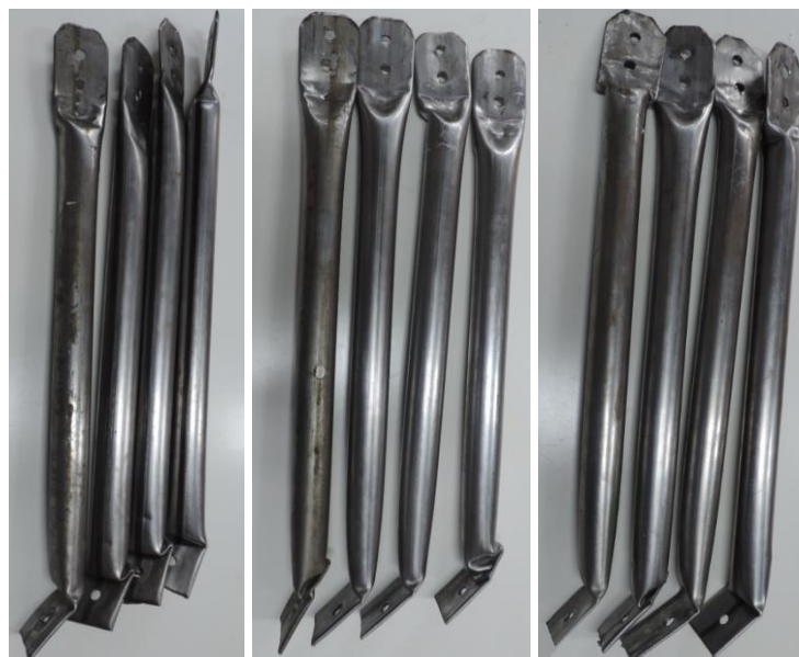
(c) Mecanismo de ruptura das barras
