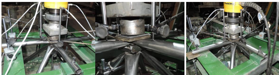
(d) Ensaio L igação T ípica com D istanciador com C oncreto E ncapsulado – LTDCE
