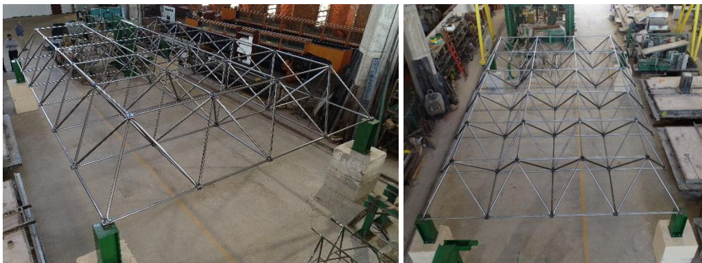
(e) LTDCEA na posição de ensaio
