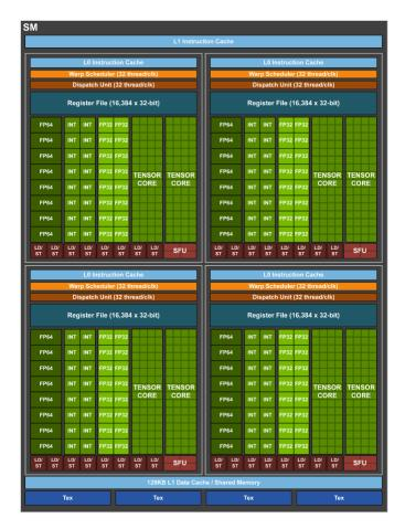
Figura 3.2: Arquitetura da SM da GPU NVidia GV100 [83].
