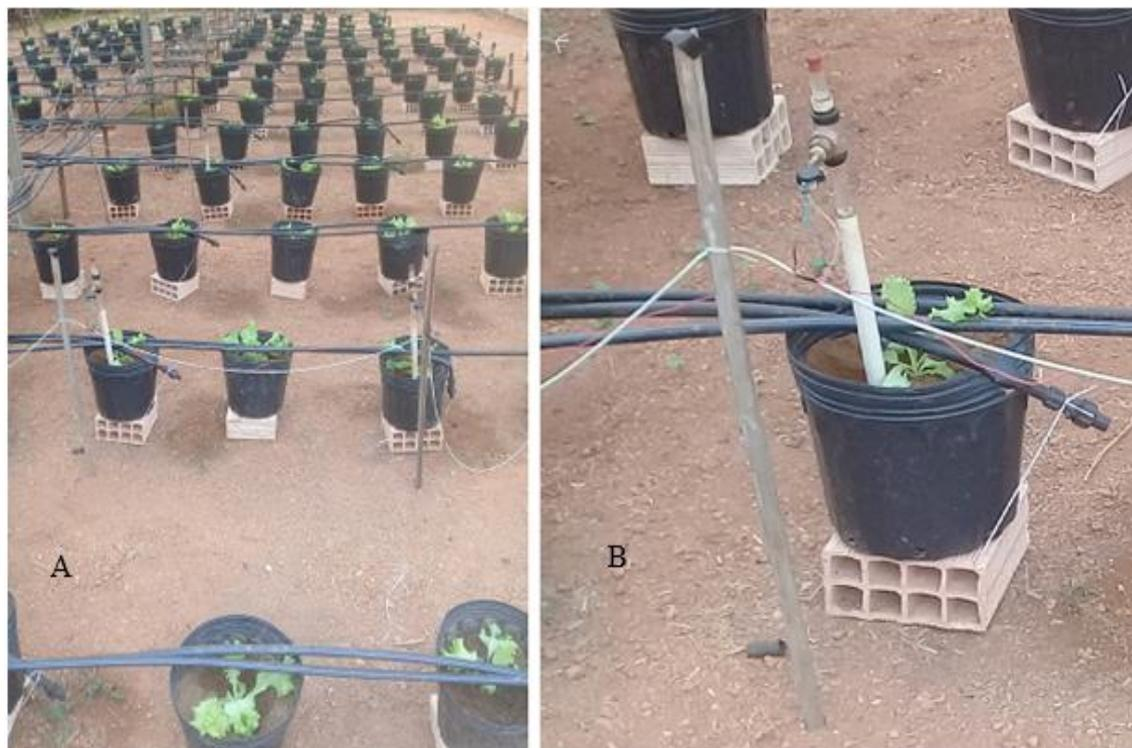
**Figura 6-2.** Disposição geral das embalagens e tensiômetros eletrônicos (A); detalhe do tensiômetro eletrônico instalado no interior da embalagem (B).
