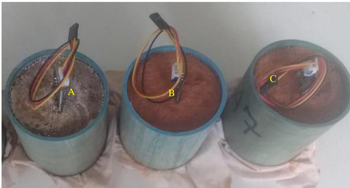
**Figura 7-2.** Sensores capacitivos SKU:SEN0193 instalados nos corpos de prova preenchidos com Neossolo Regolítico (A), Latossolo Vermelho (B) e Latossolo Vermelho Amarelo (C).
