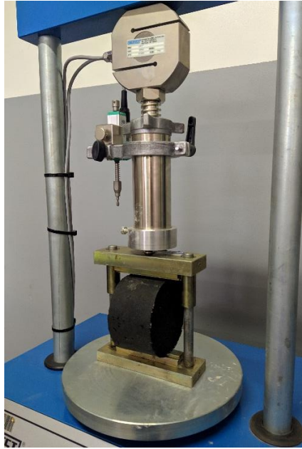
Figura 3.13 - Ensaio de resistência a tração por compressão diametral
