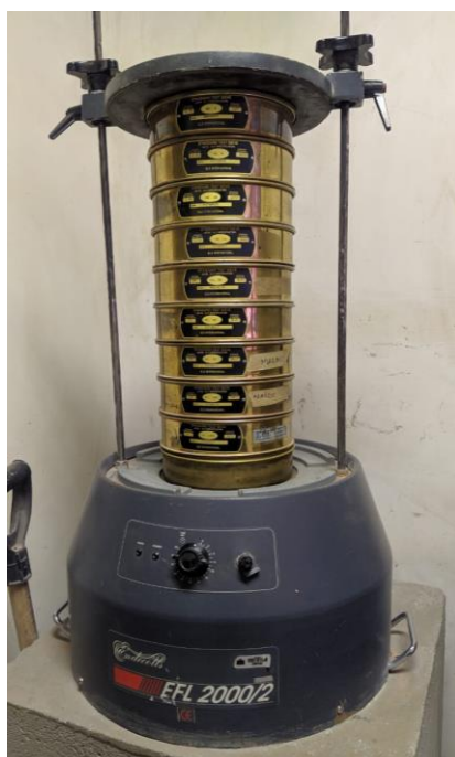
Figura 3.4 - Agitador mecânico com as peneiras utilizado para os ensaios de análise granulométrica por peneiramento
