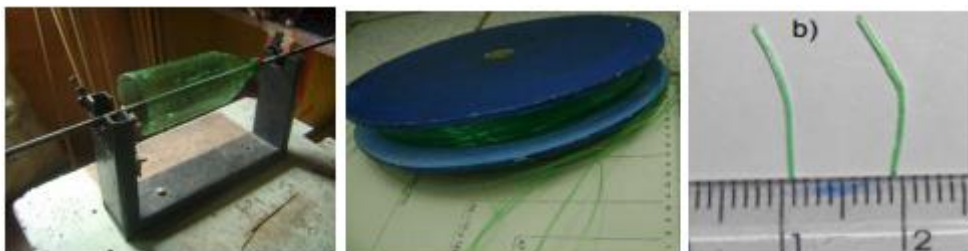
Figura 2.6 - Processo de fabricação de fibras de PET com desfiadora artesanal (Meneses, 2011)
