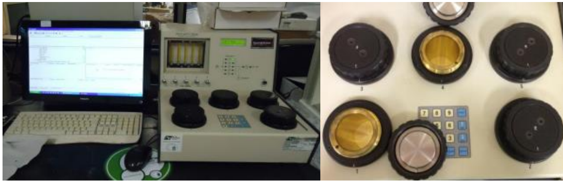
Figura 3.6 - Equipamento utilizado para determinar a densidade real dos grãos (Chrusciak, 2013)
