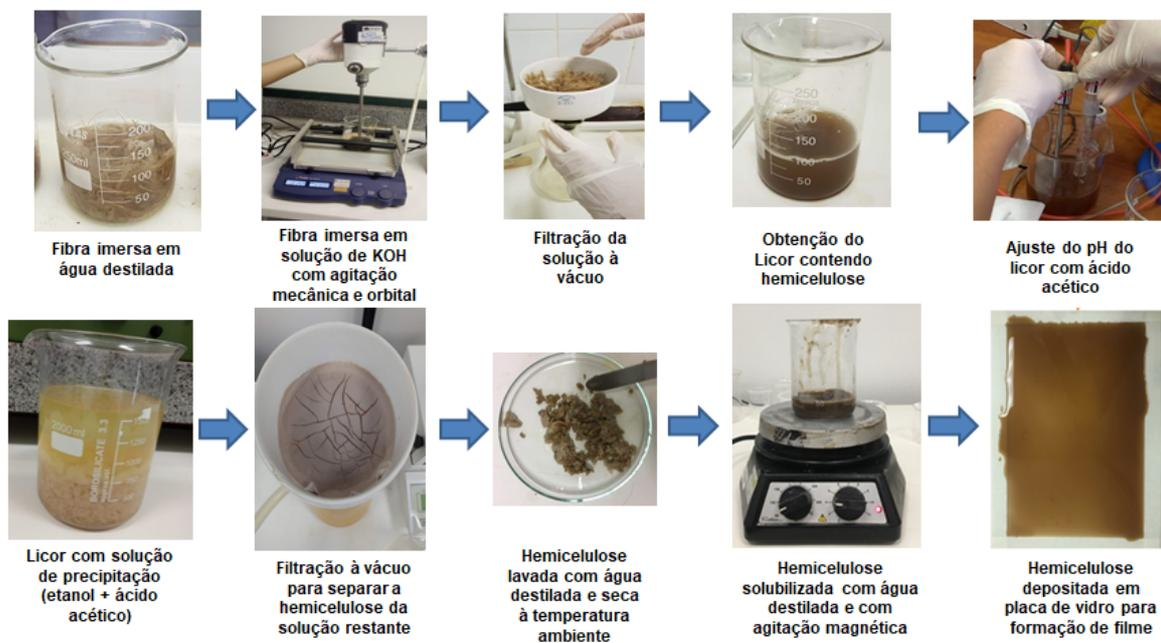
Figura 6 – Etapas realizadas para a extração da hemicelulose das fibras de juta e confecção dos filmes por moldagem por água.
