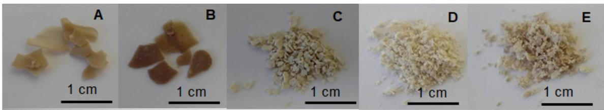
Figura 20 - Blendas de Hemicelulose 10 – PHB 65 – Glicerol 25 (A), Hemicelulose 20 – PHB 60 – Glicerol 20 (B), Hemicelulose 30 – PHB 55 – Glicerol 15 (C), Hemicelulose 40 – PHB 50 – Glicerol 10 (D) e Hemicelulose 50 – PHB 45 – Glicerol 5 (E), preparadas com ácido acético.
