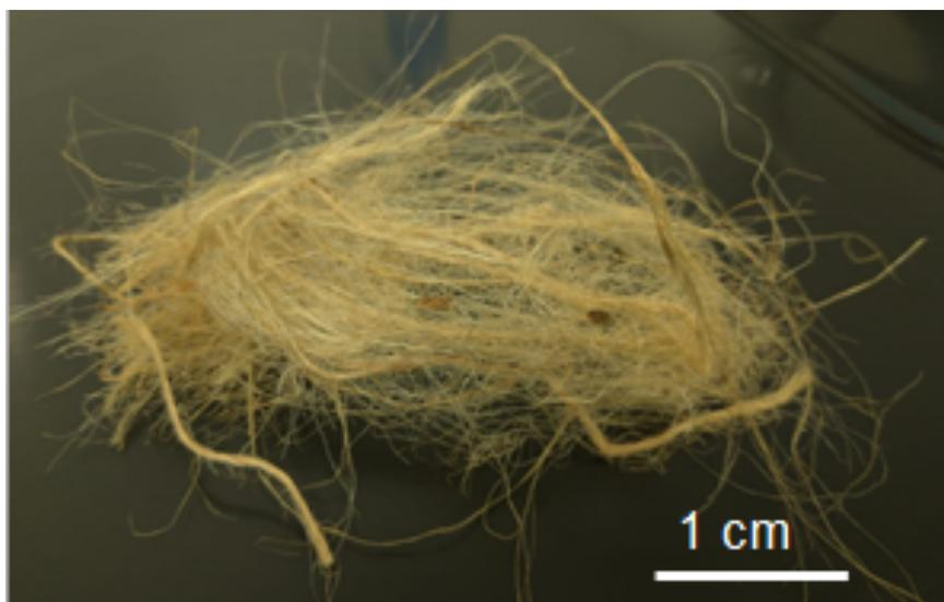
Figura 2 - Fibra de juta usada para a extração da hemicelulose neste trabalho.
