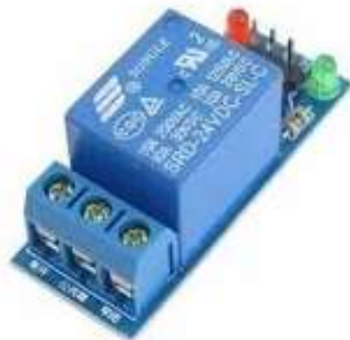
Figura 3.6: Módulo Comutador eletromecânico 5VDC e 10A.
