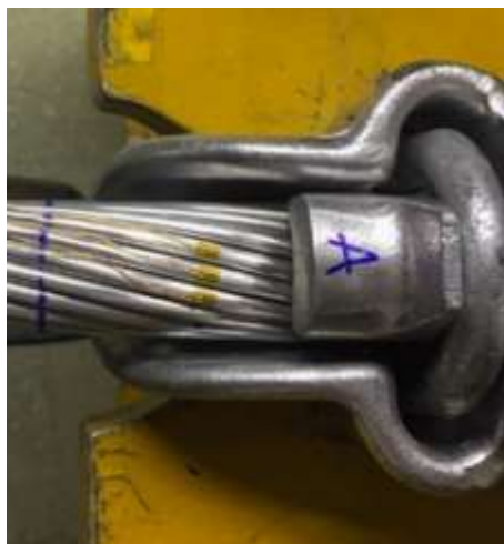
Figura 3.21: Extensômetros devidamente colados na região do UPC.
