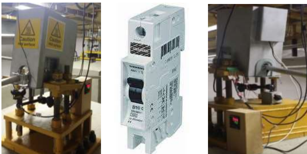
Figura 3.3: Sistemas de segurança. (a) Comunicação visual de segurança, (b) disjuntor elétrico, (c) proteção da fiação e dos conectores.
