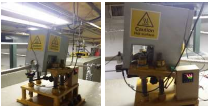
Figura 3.22: Cúpula devidamente posicionada na bancada de ensaios de fadiga.
