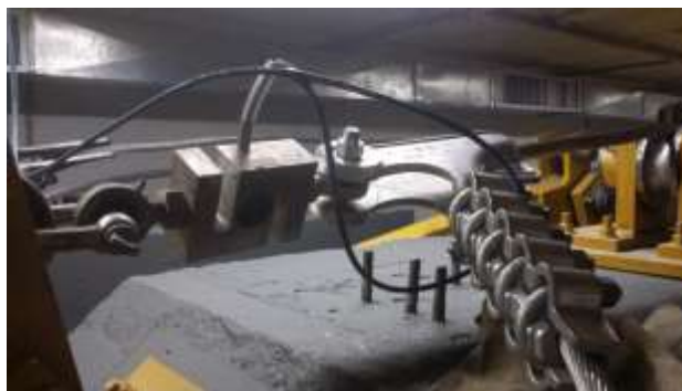
Figura 3.17: Célula de carga e grampo de ancoragem.
