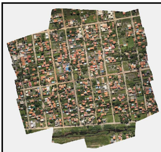
Figura 73. Ortomosaico corrigido da área 1, com 12,6 cm de resolução espacial. Fonte: Elaborada pelo autor.
