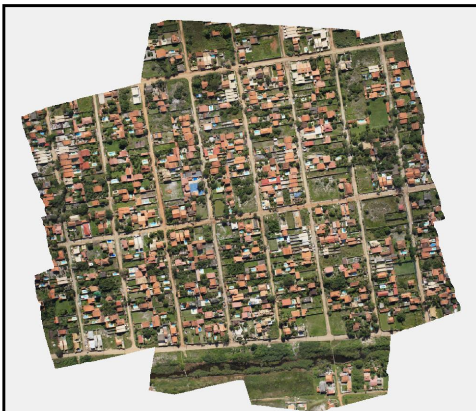
Figura 52. Ortomosaico da área 1 com 12 cm de resolução. Fonte: Elaborada pelo autor.
