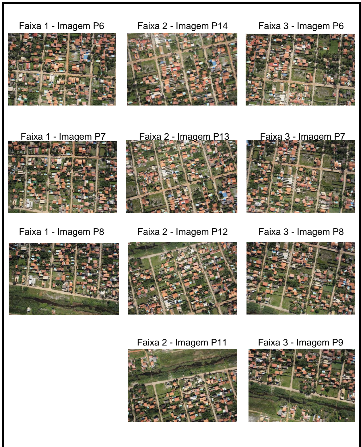
Figura 67. Três faixas de voo da primeira área de estudo, com suas imagens ópticas originais, sendo 5 imagens na faixa 1 (P4 a P8), coluna da esquerda, 6 imagens na faixa 2 (P11 a P16), coluna central, e 6 imagens na faixa 3 (P4 a P9), coluna da direita. Fonte: Elaborada pelo autor.
