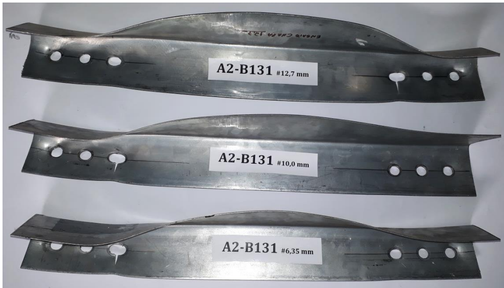
Cantoneiras 75x75#1,55 mm, (A2-B131) conectadas por uma aba, com uma linha de parafusos nas chapas de fixação com espessuras de 6,35 mm, 10,0 mm e 12,7 mm
