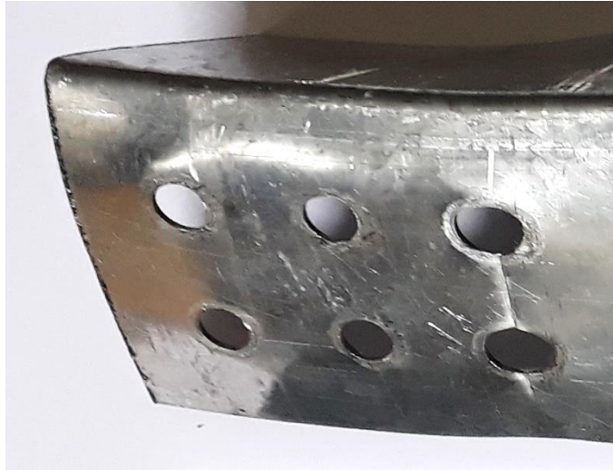
Figura 4.7 – Ruptura da seção líquida ocorrida numa cantoneira com uma aba conectada e duas linhas de parafusos
