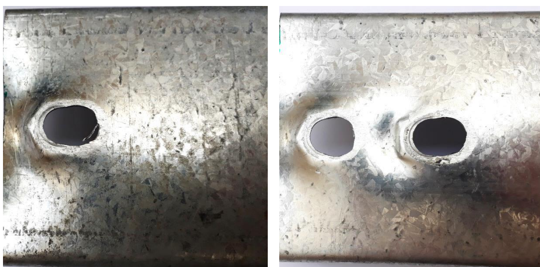
Figura 4.14 – Esmagamento na borda dos furos em perfis U com ligação pela alma com uma linha de parafusos.
