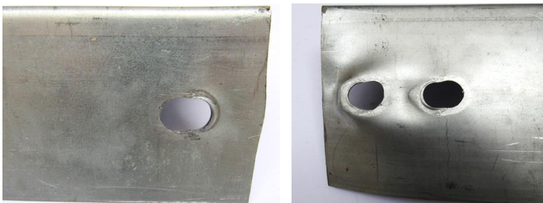
Figura 4.12 – Esmagamento ocorrido em cantoneiras com uma aba conectada com uma linha de parafusos
