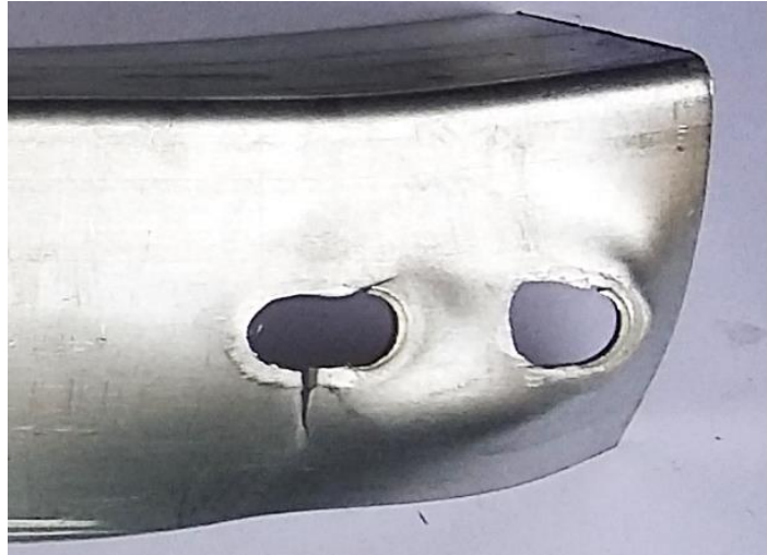
Figura 4.5 – Ruptura da seção líquida ocorrida em cantoneira com uma aba conectada.
