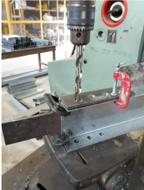
Figura 3.19 – Execução dos furos nos modelos.
