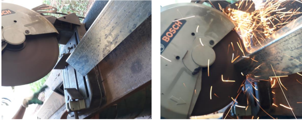
Figura 3.14 – Corte das barras de aço para confecção dos modelos a serem ensaiados
