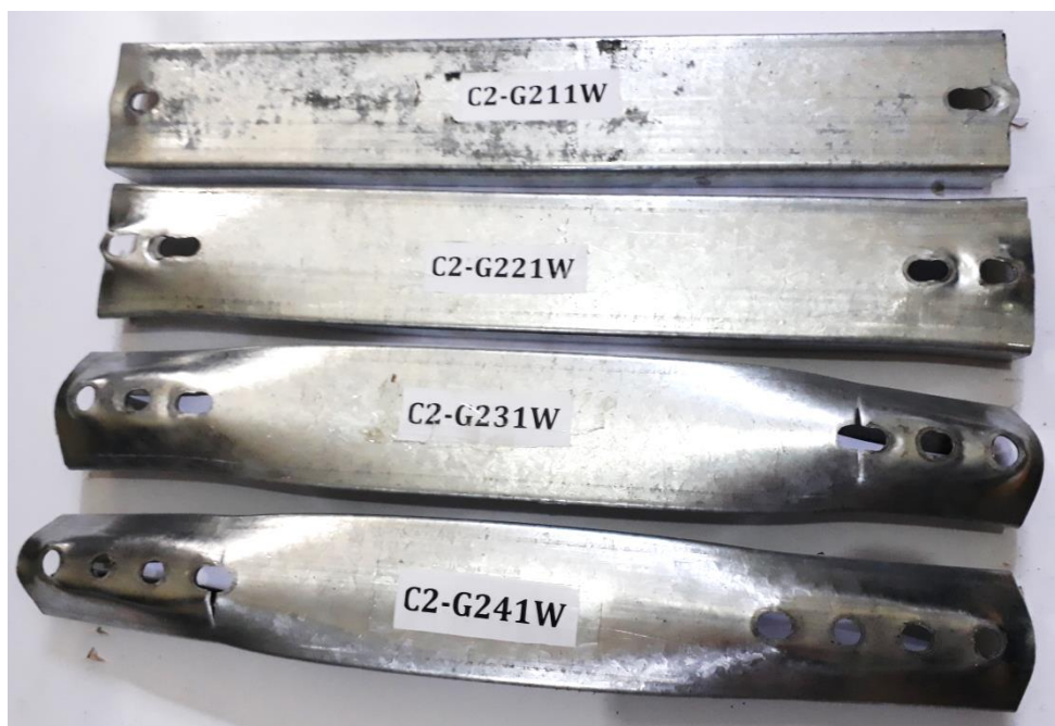
Figura 4.23 – Deformações em perfis U conectados pela alma com uma linha de parafusos
