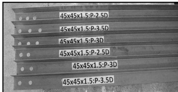
Figura 2.14 – Disposição dos furos nos modelos de Prabha et al. (2011).
