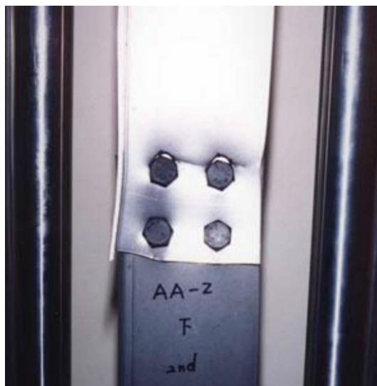
Figura 2.16 – Modo de ruptura típico do modelo (PAN e CHIANG, 2002).
