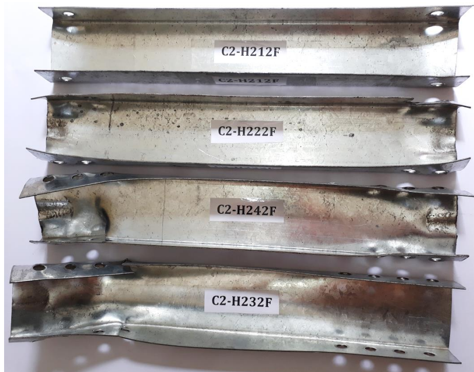
Figura 4.25 – Deformações em perfis U conectados pelos flanges com uma linha de parafusos em cada flange
