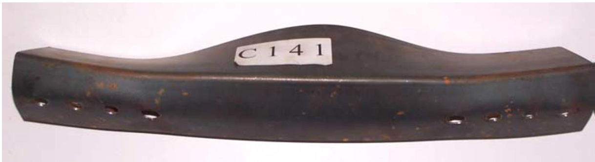
Figura 2.27 – Deformada da cantoneira C141 ensaiada (DE PAULA, 2006)
