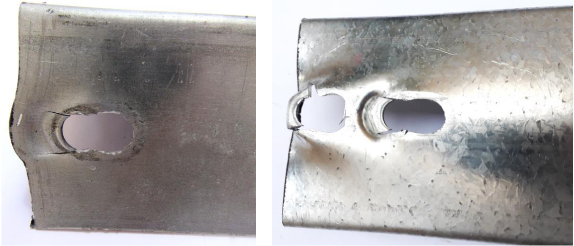
Figura 4.17 – Falha por esmagamento combinado com início de rasgamento em perfis U com uma linha de parafusos.
