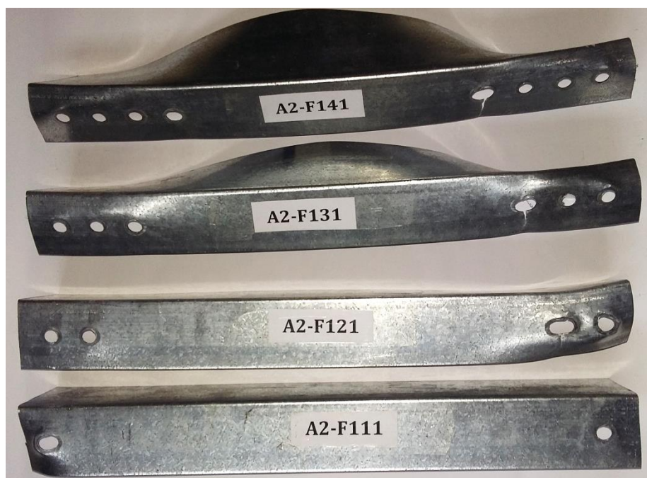
Figura 4.20 – Deformações em cantoneiras de abas desiguais, conectadas nas abas menores
