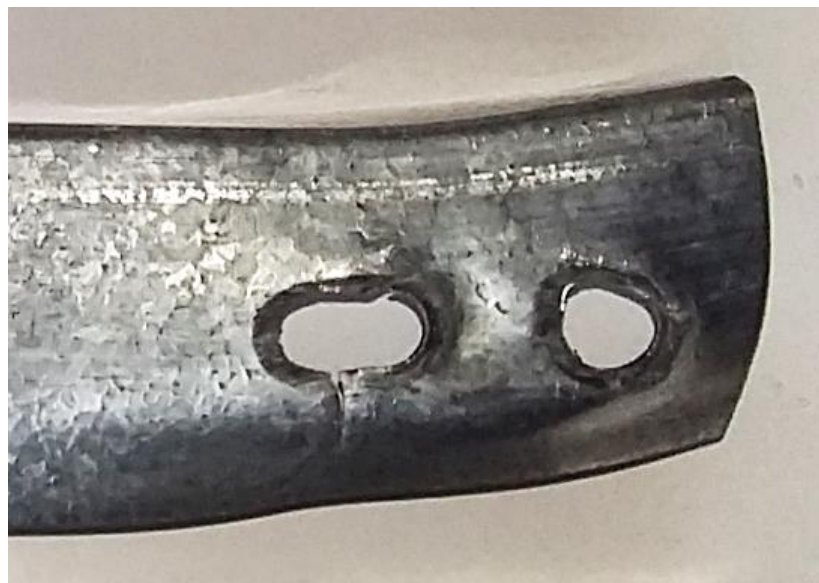
Figura 4.16 – Falha por esmagamento combinado com início de ruptura da seção líquida em cantoneiras com uma linha de parafusos.
