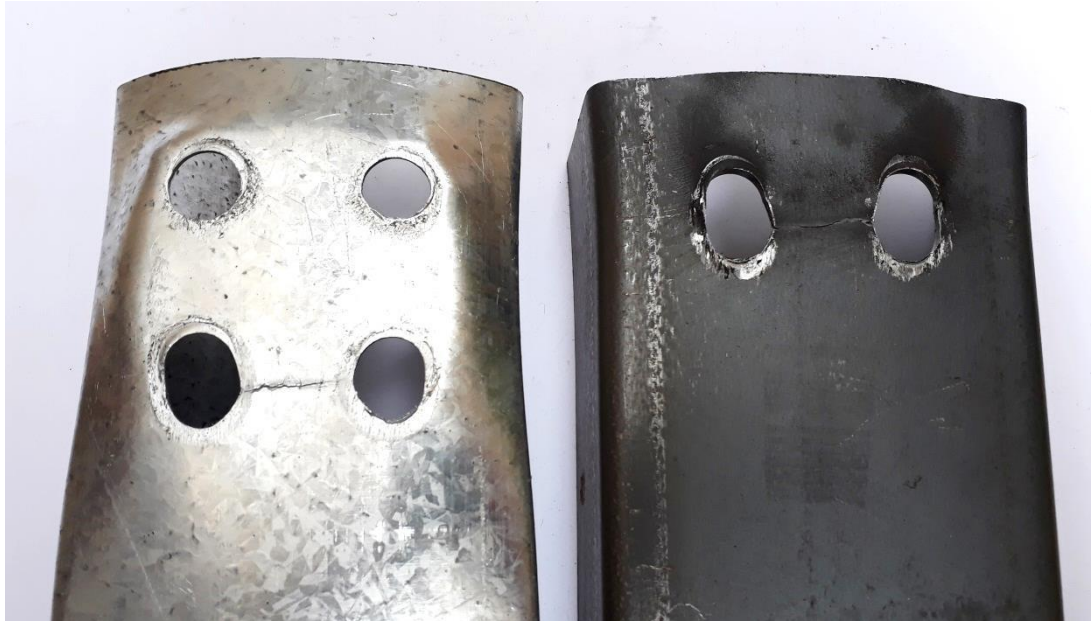
Figura 4.9 – Ruptura da seção líquida em perfis U conectados somente pela alma, com duas linhas de parafusos.
