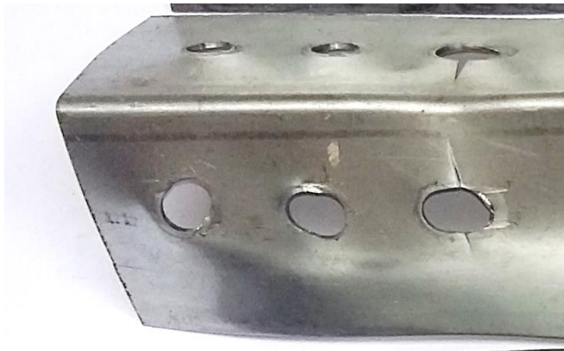
Figura 4.6 – Ruptura da seção líquida ocorrida em cantoneira com ambas as abas conectadas.
