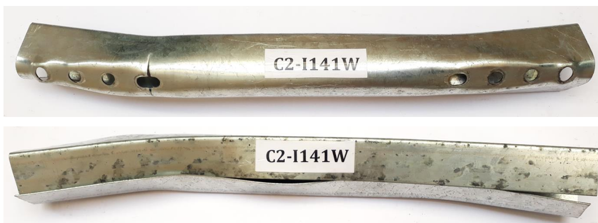
Figura 4.22 – Excessiva deformação nos flanges do perfil U conectado com uma seção de parafusos
