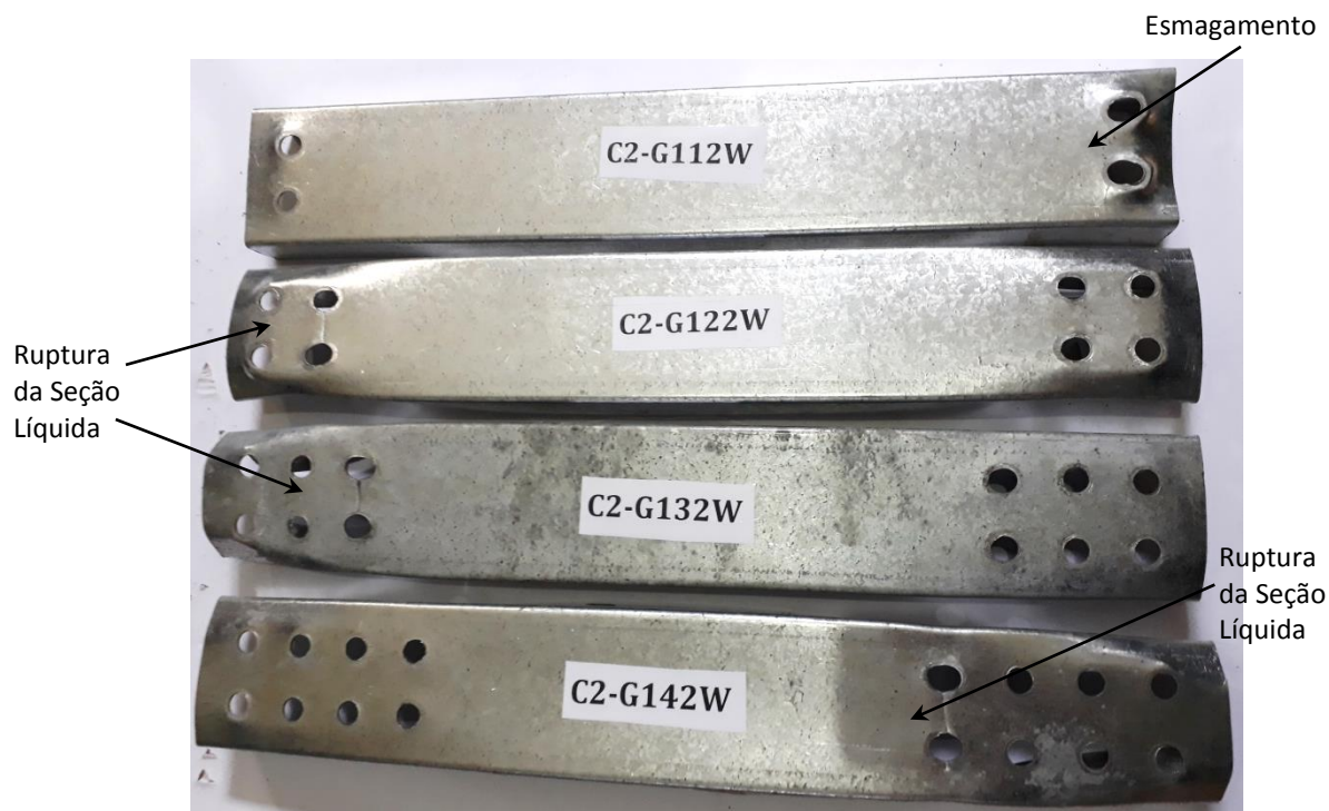
Figura 4.4 – Aspecto da deformada dos modelos com perfis U parafusados com duas linha de furos, após os ensaios.
