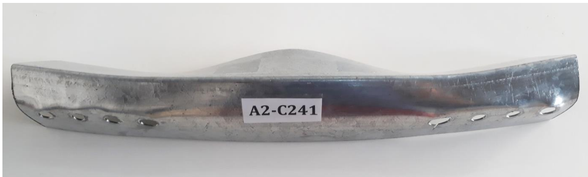
Figura 4.18 – Aspecto da deformação sofrida por uma cantoneira tracionada ligada por apenas uma das abas com uma seção de parafusos.
