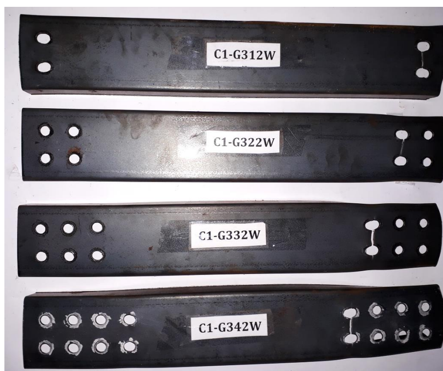
Figura 4.24 – Deformações em perfis U conectados pela alma com duas linha de parafusos
