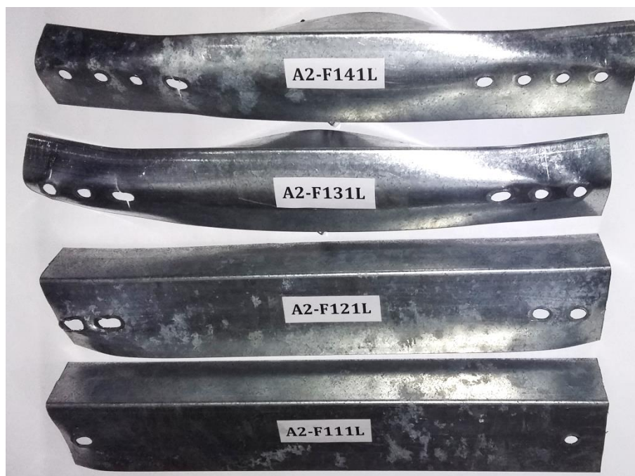
Figura 4.19 – Deformações em cantoneiras de abas desiguais, conectadas nas abas maiores
