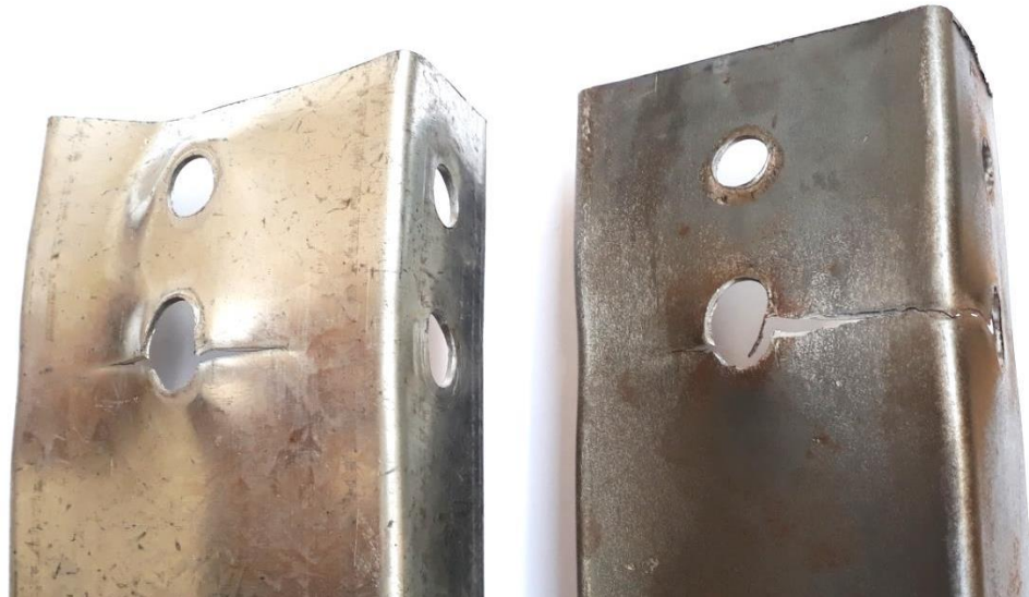
Figura 4.11 – Ruptura da seção líquida em perfis U conectados pela alma e pelos flanges.
