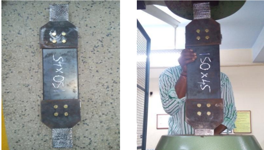
Figura 2.31 – Modelo de ensaio realizado em perfis U laminados a frio (JAGHAN e PADMAPRIYA, 2016)
