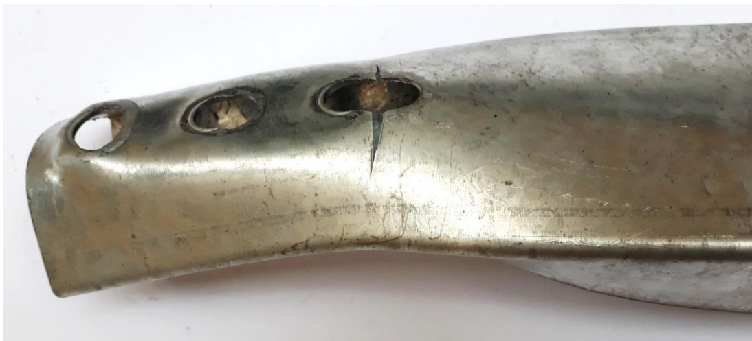
Figura 4.8 – Ruptura da seção líquida num perfil U conectado pela alma com apenas uma linha de parafusos.
