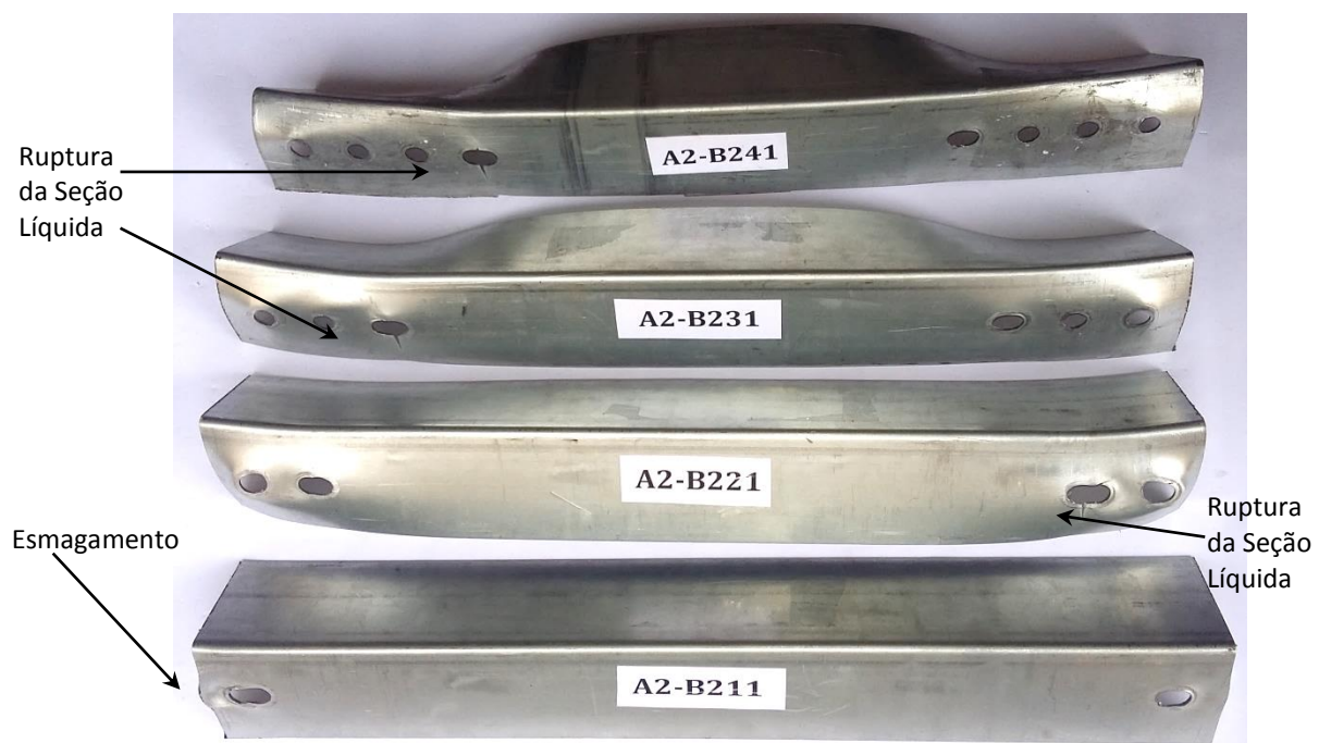
Figura 4.3 – Aspecto da deformada dos modelos com cantoneiras parafusadas com uma linha de furos, após os ensaios.
