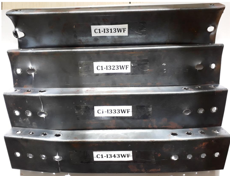
Figura 4.26 – Deformações em perfis U conectados pela alma e pelos flanges
