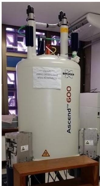
Figura 17 – Foto do equipamento de Ressonância Magnética Nuclear. Fonte: arquivo do Laboratório de Farmacognosia, UnB
