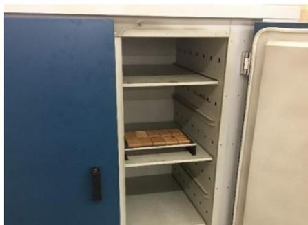
**Figura 6)** Amostras de madeira na estufa para processo de secagem.
