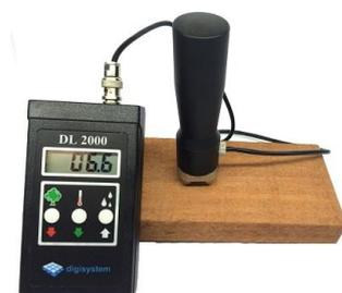
**Figura 4)** Aparelho medidor de umidade para madeiras DL 2000, Digisystem™.
