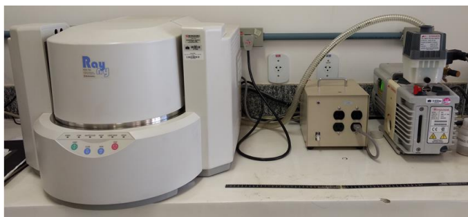
Figura 2.8: Foto tirada do equipamento de EDX utilizado nesta pesquisa.
