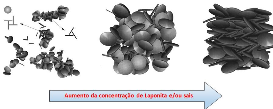
Figura 1.11: Configurações típicas de "castelos de cartas" com maior concentração da esquerda para a direita. Os anéis típicos de três e quatro plaquetas são esquematicamente ilustrados como inserts; As setas apontam para tais anéis que ocorrem dentro dos clusters [107].
