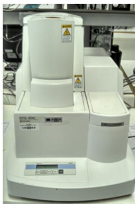
Figura 2.20: Foto tirada do equipamento de TGA usado para fazer as medidas [120].
