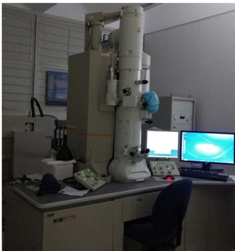
Figura 2.18: Foto tirada do Microscópio JEOL mod. JEM2100 – EDS que foi usado nas medidas
