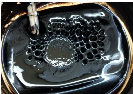
Figura 1.4: Representação de um ferrofluido. Fluido sintetizado em um curso no GFC (Grupo de Fluido Complexo), Instituto de Física (IF) da Universidade de Brasília (UnB)
