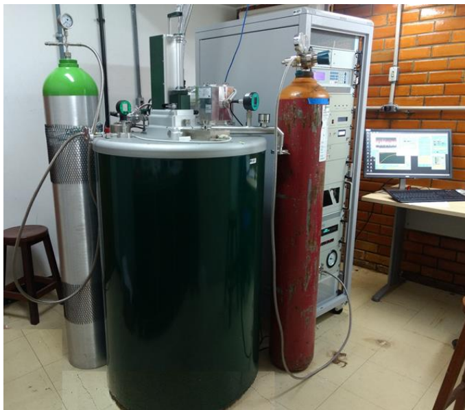
Figura 2.21: Foto tirada do Magnetômetro SQUID S700X-R produzido pela CRYOGENIC Ltd usado para fazer as medidas magnéticas apresentadas nesta tese.
