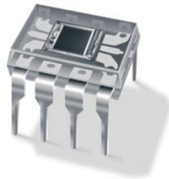
Figura 3.6. Dispositivo OPT101. Fonte: [75].
