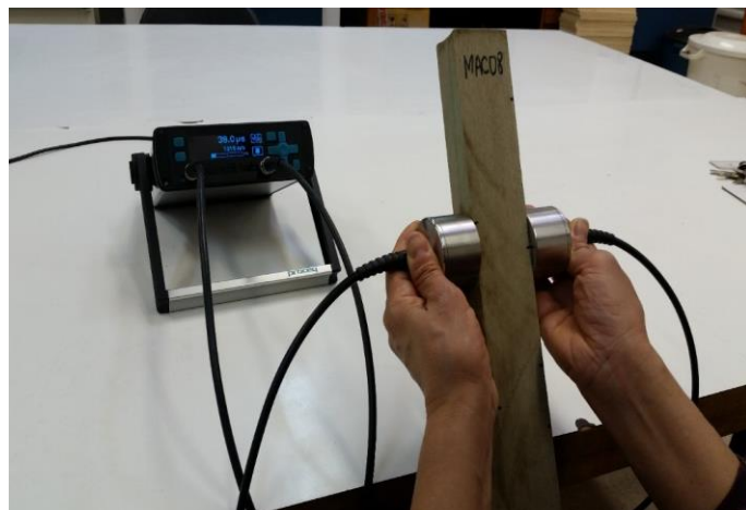
Figura 11. Pontos de coleta de dados referentes às ondas ultrassônicas (Adaptado de TELES (2014)).
