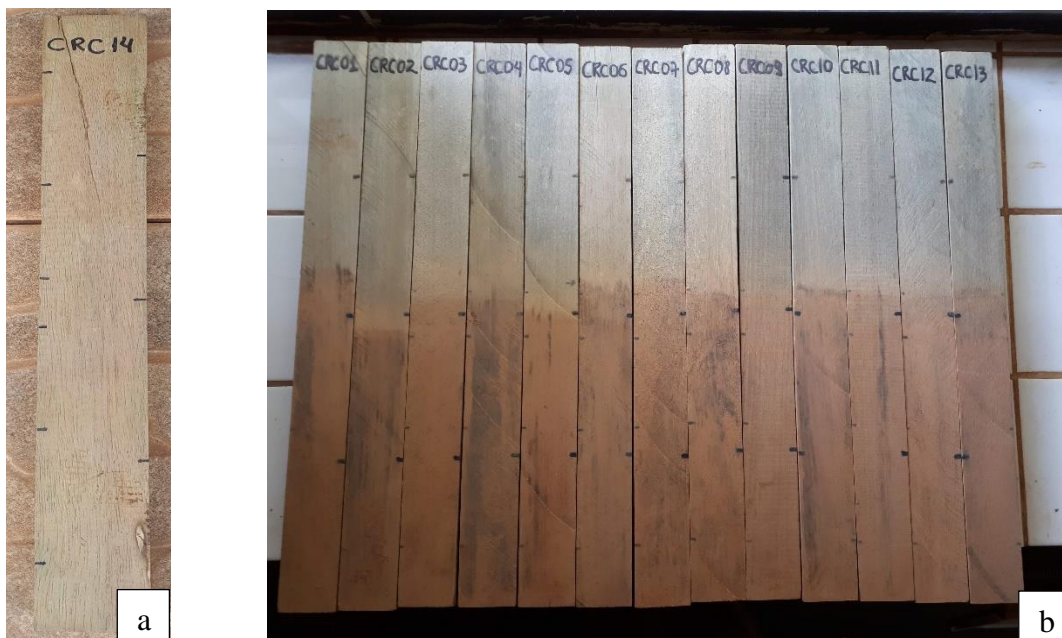
Figura 24. Aspecto visual das amostras de curupixá tratadas com CCA-C (a) antes e (b) após exposição em campo de apodrecimento.
