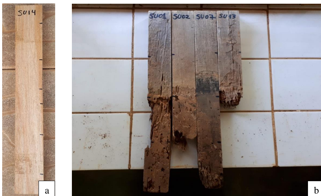
Figura 19. Aspecto visual das amostras de sumaúma sem tratamento químico (a) antes e (b) após exposição em campo de apodrecimento.
