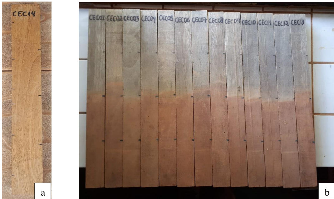
Figura 26. Aspecto visual das amostras de cerejeira tratadas com CCA-C (a) antes e (b) após exposição em campo de apodrecimento.
