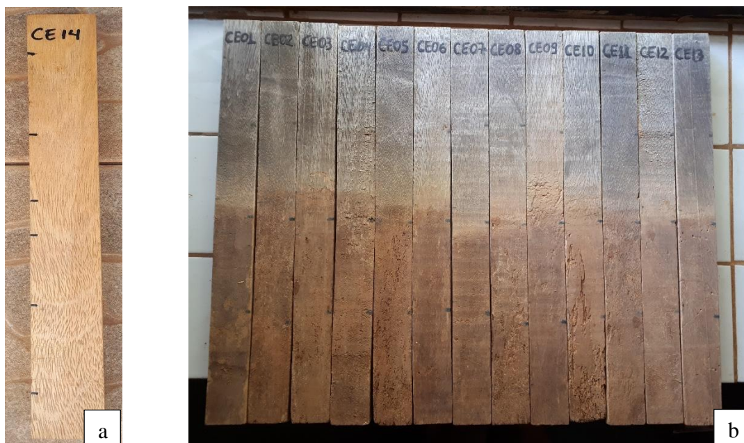
Figura 25. Aspecto visual das amostras de cerejeira sem tratamento químico (a) antes e (b) após exposição em campo de apodrecimento.
