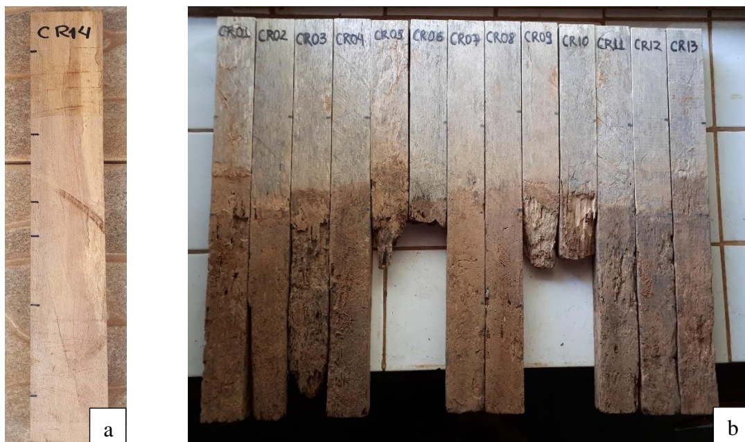
Figura 23. Aspecto visual das amostras de curupixá sem tratamento químico (a) antes e (b) após exposição em campo de apodrecimento.
