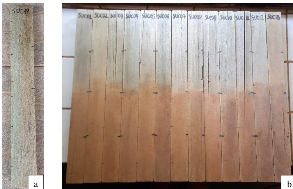
Figura 20. Aspecto visual das amostras de sumaúma tratadas com CCA-C (a) antes e (b) após exposição em campo de apodrecimento.
