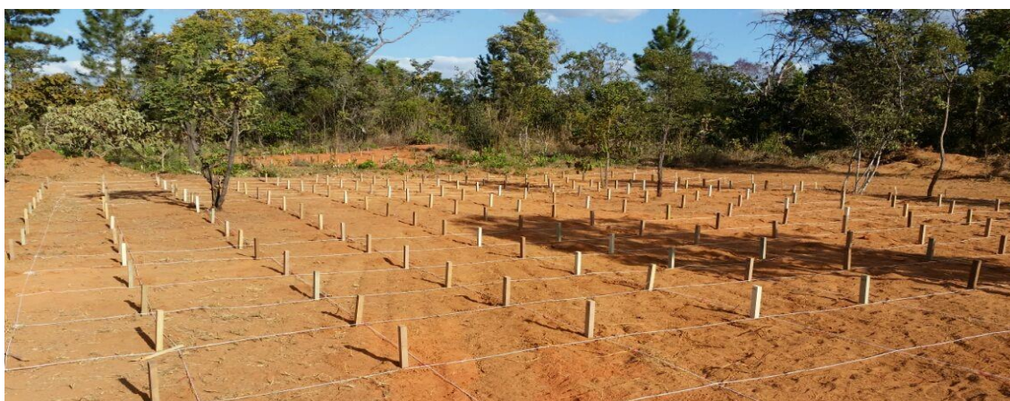
Figura 10. Campo de apodrecimento instalado em maio de 2016 na Fazenda Água Limpa/UnB.
