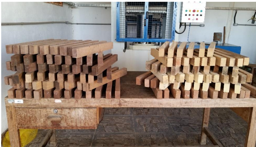
Figura 9. Acomodação das amostras para fixação de ingredientes ativos após o tratamento químico.
