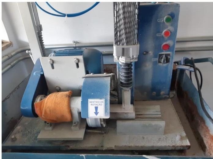
**Figura 7:** Retífica utilizada em substituição ao capeamento com enxofre.
