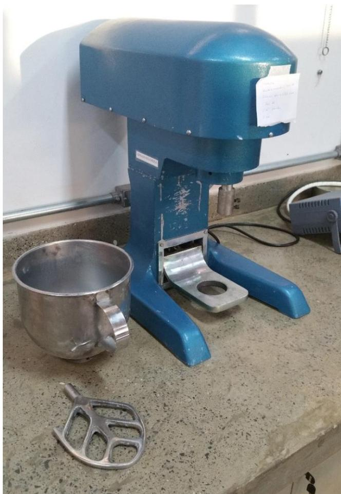
**Figura 5:** Misturador mecânico.
