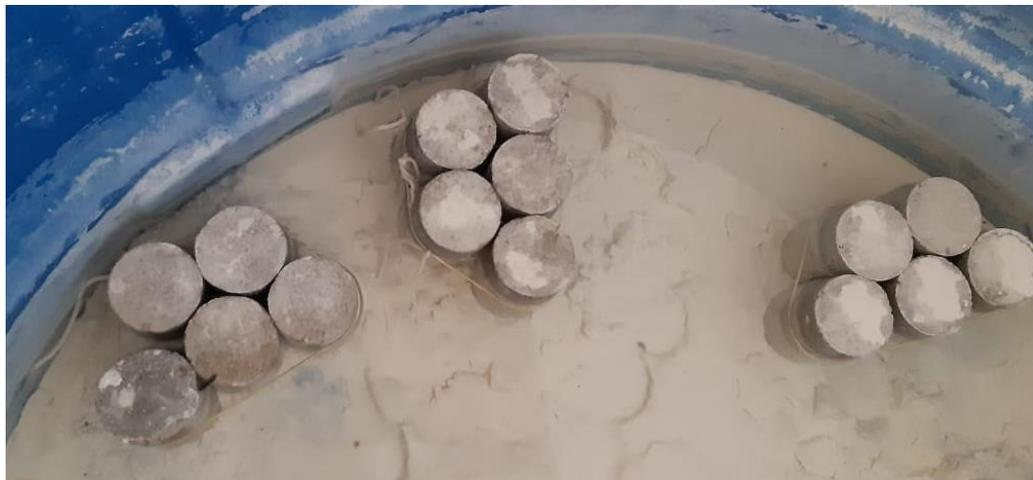
**Figura 6:** Cura dos corpos de prova em solução saturada de cal.
