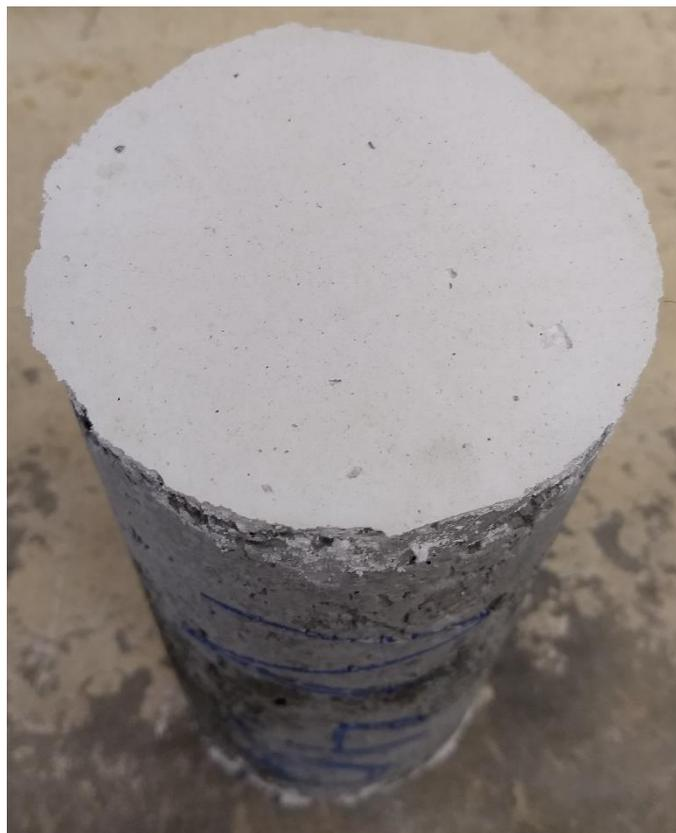
Figura 24 - Capeamento com gesso dos corpos de prova.
