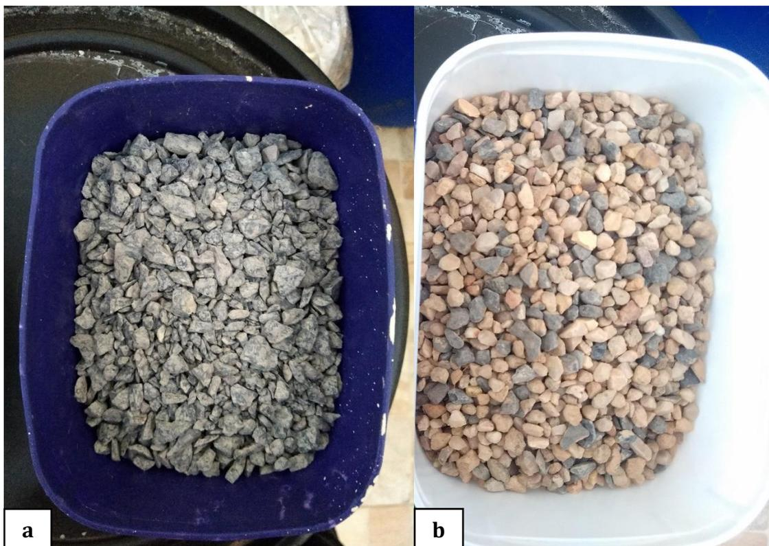
Figura 15 –(a) Agregado gráúdo natural e (b) agregado gráúdo de RCD (esquerda) utilizados na confecção dos concretos estudados.
