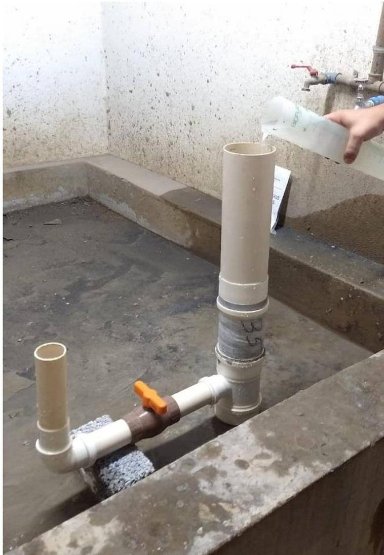
Figura 28 – Preenchimento do equipamento para ensaio de permeabilidade.
