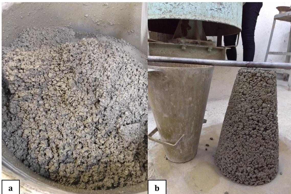
Figura 20 – (a) Concreto permeável em estado fresco; (b) ensaio de abatimento de tronco de cone.
