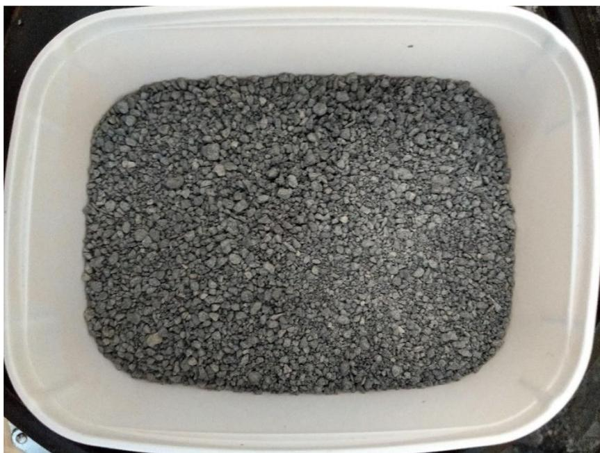
Figura 17 – Agregado miúdo utilizado.
