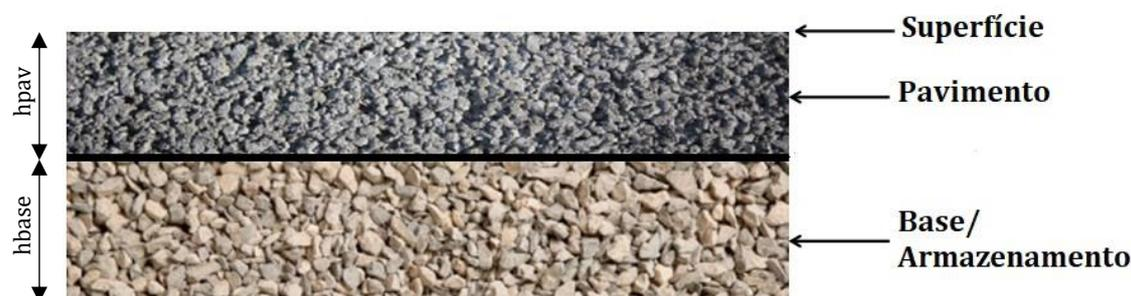
Figura 55 – Detalhamento das camadas do pavimento permeável utilizadas na simulação e o subleito.
