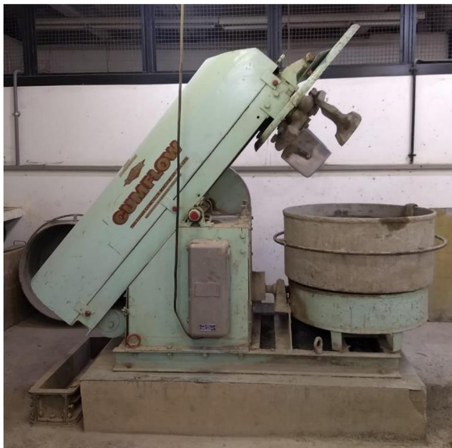
Figura 19 – Betoneira utilizada para moldagem dos concretos.
