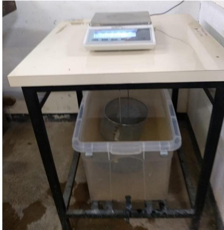
Figura 25 – Pesagem de corpo de prova em balança hidrostática.
