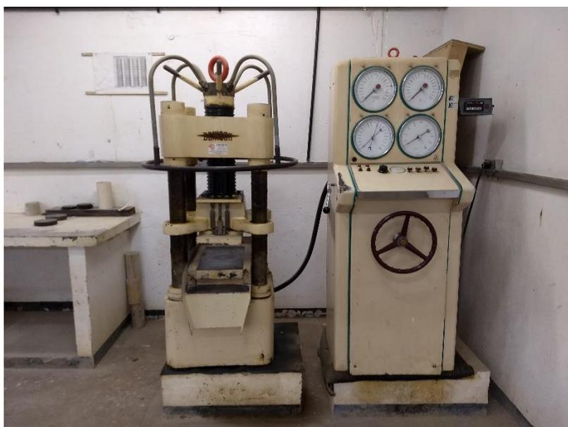
Figura 22 - Máquina de ensaio de resistência à compressão.
