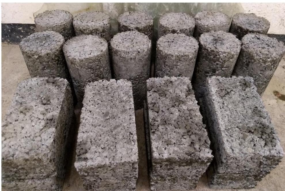
Figura 21 - Corpos de prova após serem desmoldados.
