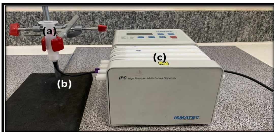
Figura 8. Sistema MISPE. (A) cartucho de extração; (B) tubo de vitton e (C) bomba peristáltica.
