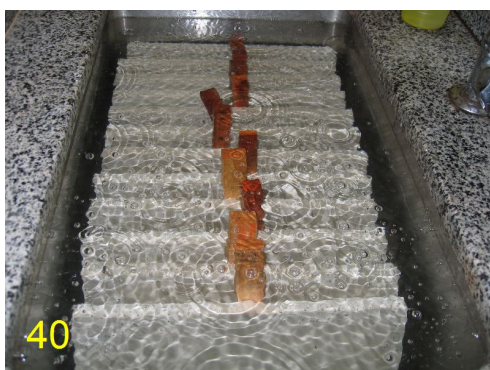
Figura 40 – Corpos-de-prova colocados em tanque com água, logo após a imersão.
