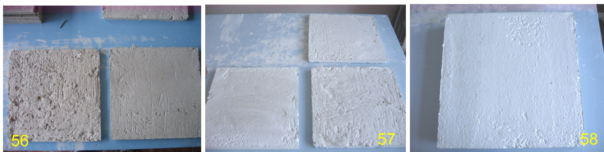
Figura 56 – Compósitos de gesso com fibras de bambu e traço 1:0,50 (gesso:água).
