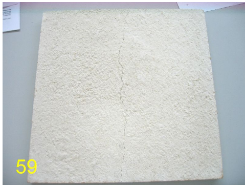
Figura 59 – Fissura em corpo-de-prova de compósito com fibras de bambu, após ensaio.
