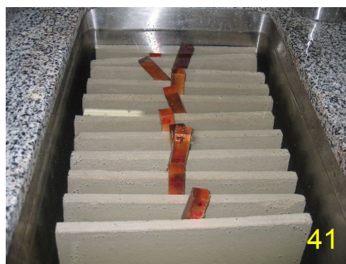
Figura 40 – Corpos-de-prova colocados em tanque com água, logo após a imersão.
