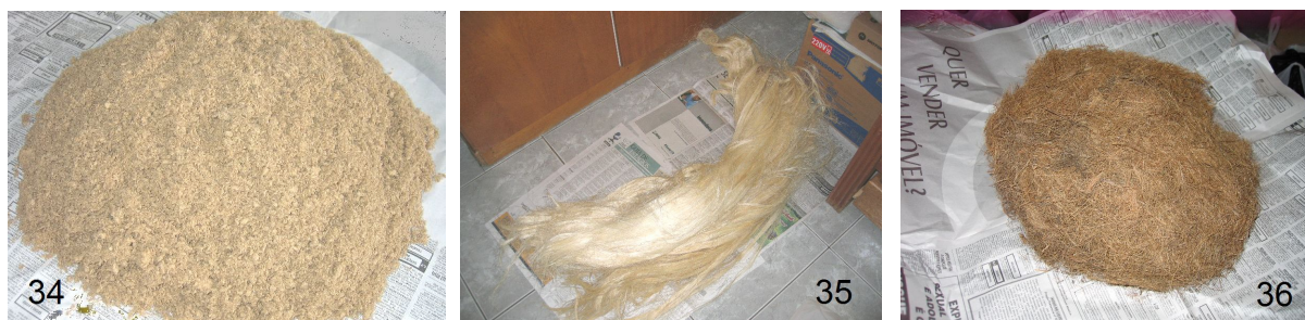
Figura 34 – Polpa de bambu. Figura 35 - Fibra de sisal inteira, em fardo. Figura 36 – Fibra de coco limpa e cortada com 2 cm de comprimento, aproximadamente.
