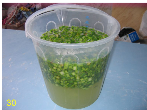
Figura 30 – Recipiente contendo água natural com pedaços de cacto após dois dias de repouso. Figura 31 - Mucilagem extraída em água natural sendo peneirada.
