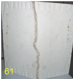
Figura 61 – Corpo-de-prova de compósito com fibras de sisal, aumento da trinca por força muscular, após ensaio.
