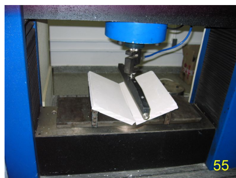
Figuras 54 e 55 – Corpo-de-prova da pasta OAQ 50 antes e após ensaio de flexão.
