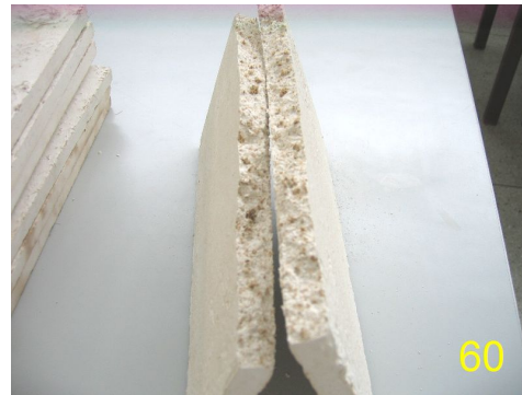
Figura 59 – Fissura em corpo-de-prova de compósito com fibras de bambu, após ensaio.
