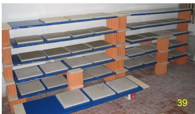
Figura 38 – Molde para a confecção dos corpos-de-prova: compensado, plástico e madeira envernizada. Figura 39 - Prateleiras revestidas por plástico onde foram colocados os corpos-de-prova e diariamente virados para cura homogênea.
