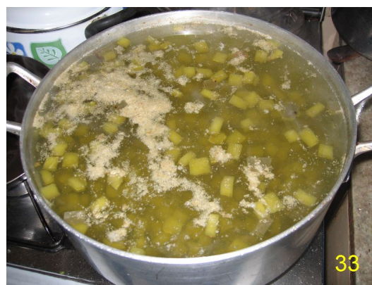
Figura 32 – Cacto colocado em panela com água e levado ao fogo. Figura 33 – Mucilagem extraída após 30 minutos de fervura dos cactos.
