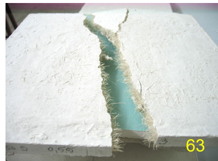
Figura 61 – Corpo-de-prova de compósito com fibras de sisal, aumento da trinca por força muscular, após ensaio.
