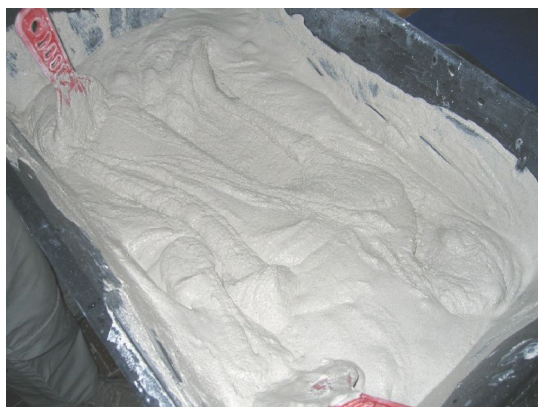
Figura 37 – Mistura homogênea da pasta com mucilagem em gel.
