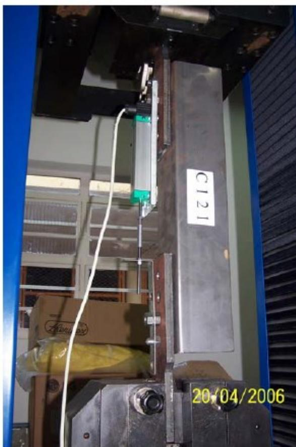
Figura 5.1 - Instalação típica da cantoneira com uma linha de parafuso na máquina universal de ensaios (PAULA, 2006).
