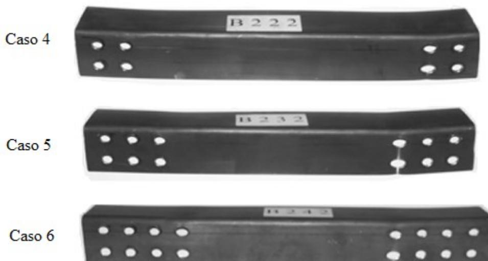
Figura 6.12 - Deformação das cantoneiras no final do ensaio experimental dos casos 4, 5 e 6.
