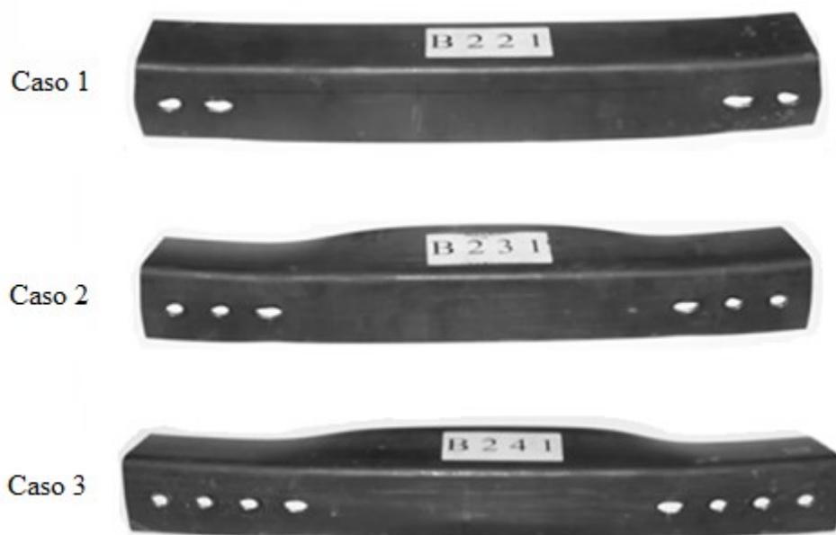
Figura 6.11 - Deformação das cantoneiras no final do ensaio experimental dos casos 1, 2 e 3.
