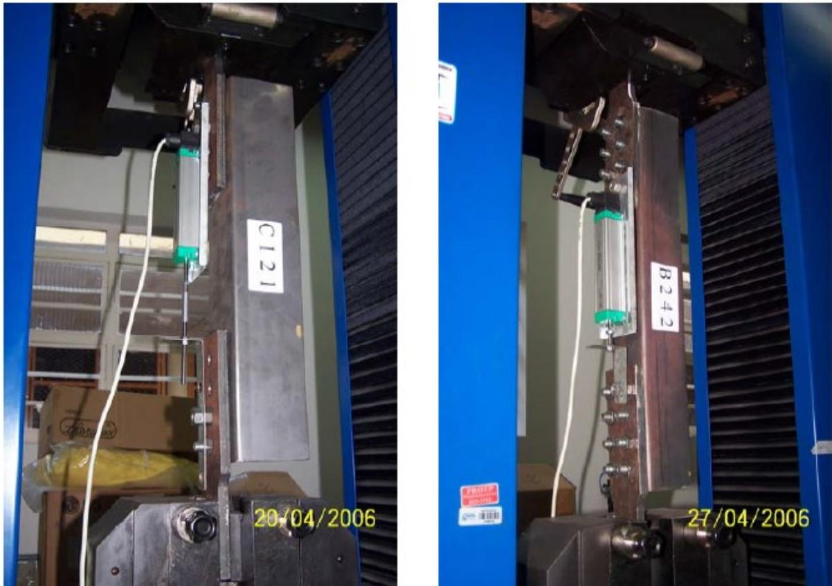
Figura 2.15 - Instalação típica de cantoneiras com uma e duas linhas de parafusos na prensa eletromecânica empregada nos ensaios (PAULA, 2006).
