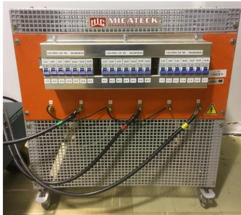
Figura 3.5 – Detalhe da carga resistiva.
