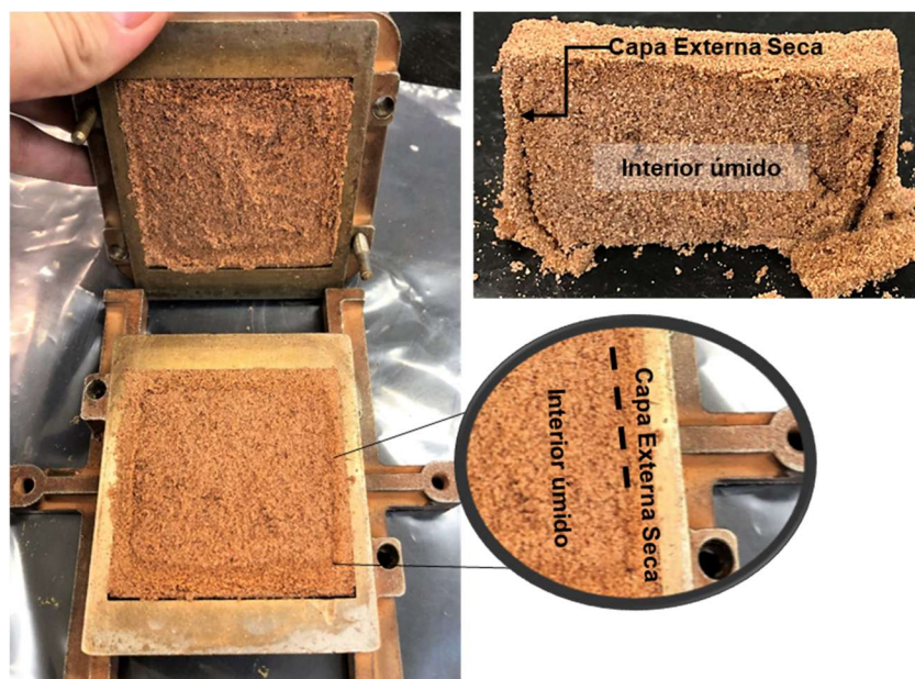
Figura 4.13. SP_2,5% 1 dia de cura, interior úmido e capinha seca.
