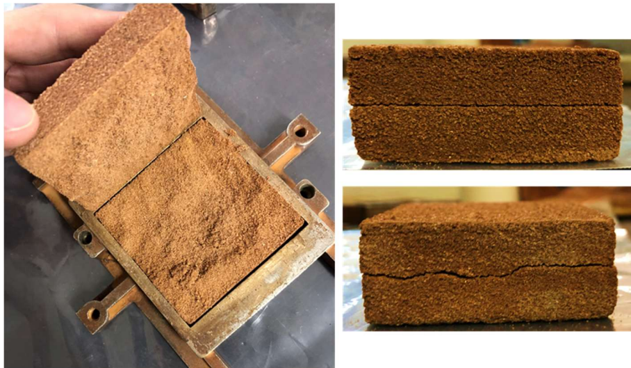
Figura 4.25. SP_5% com 45 dia de cura, após ruptura.
