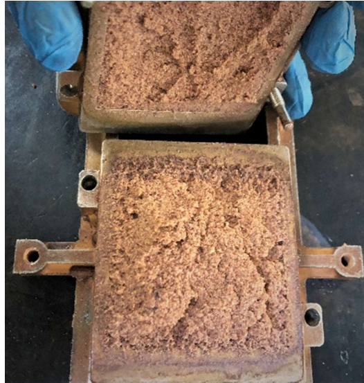
Figura 4.12. SP_2,5% sem cura, após ruptura.
