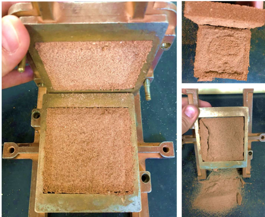
Figura 4.14. SP_2,5% 2 dias de cura, após ruptura.
