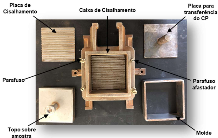
Figura 3.13. Equipamentos utilizados para a realização do ensaio.
