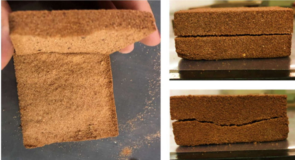
Figura 4.24. SP_5% com 15 dia de cura, após ruptura.
