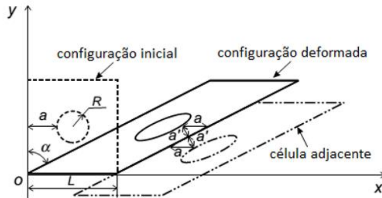
Figura 2.3 – Ilustração do mecanismo de cisalhamento de vazio (adaptado de Xue, 2008).
