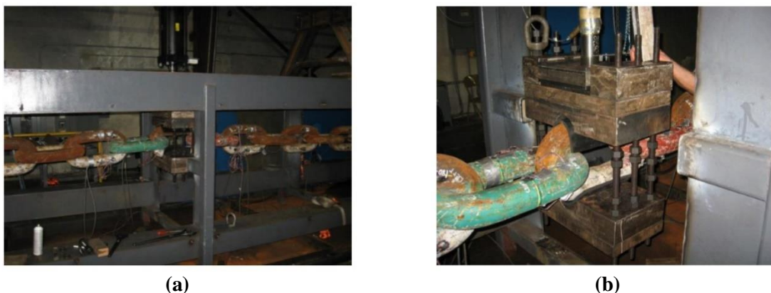
Figura 6.6 – Dispositivo utilizado por Rampi et al. (2015) para ensaio de amarras (a) e detalhe do aparato preso ao elo central (b) (fonte: Rampi et al., 2015 ).
