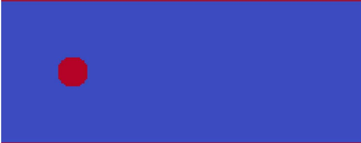
Figura 4.5: Geometria definida para o fluxo de fluido ao redor de um cilindro circular.
