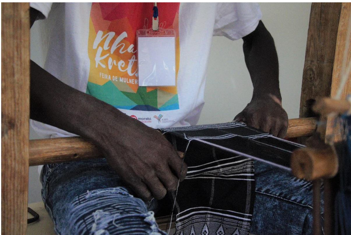
Foto 8 – Conforme o panu di terra vai sendo tecido, ele é puxado para facilitar o trabalho.
